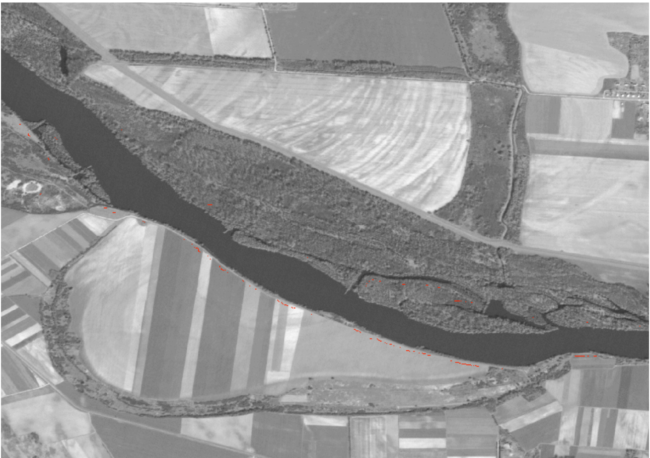
Abb. 21: Rote Bereiche sind klassifizierte Höhenstützpunkte auf Basis der Rangefilterklassifikation. Es werden vor allem flache Bereiche am südlichen Ufer klassifiziert. Vgl. ebenso Abb. 19
