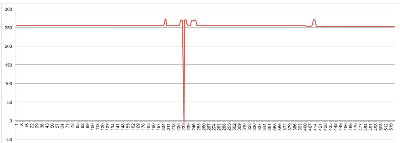
Abb. 59: 1. Höhenverlauf des 1. Centerlinesegments inklusive Brücken und Fehler
