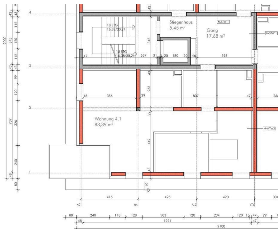
Bild 4.12: Ausschnitt Grundriss Massivbauweise
