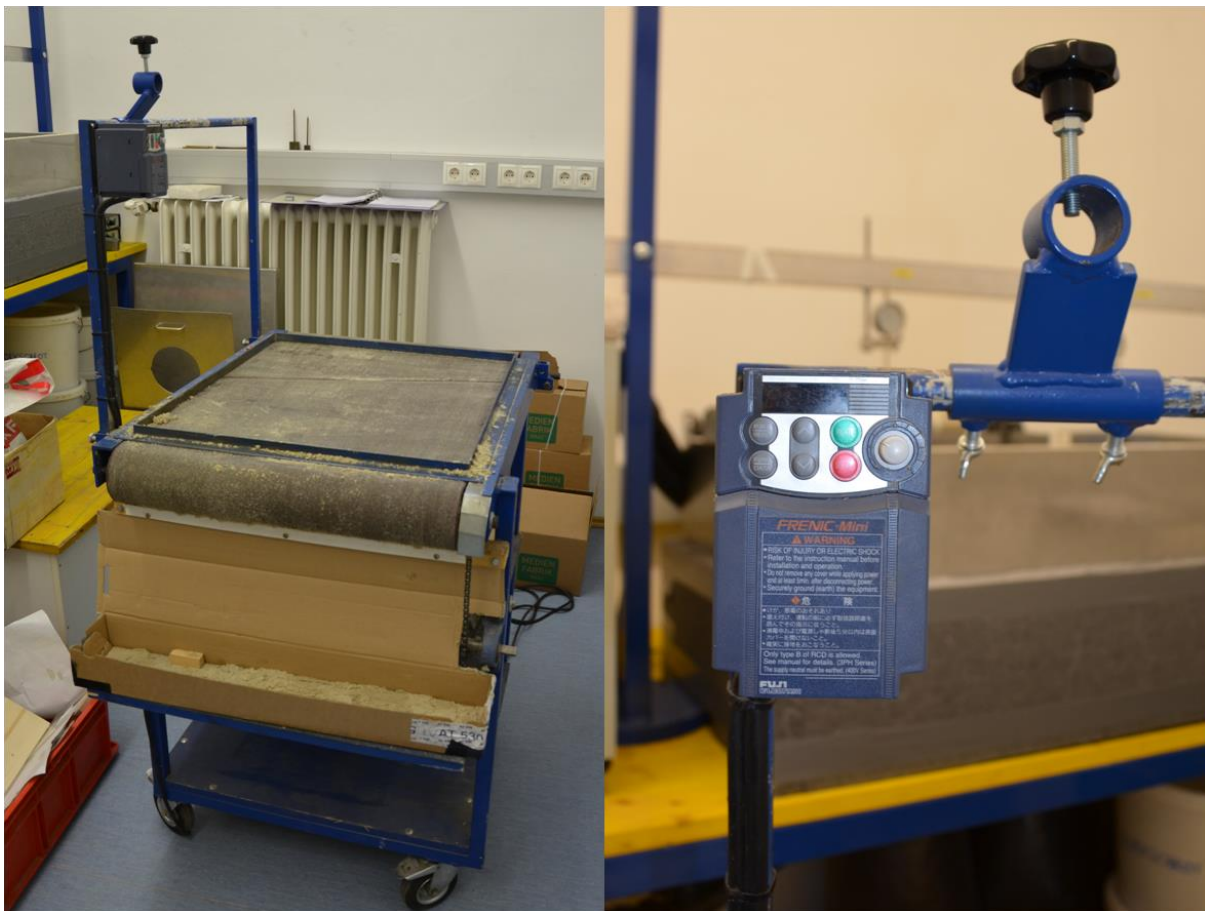
Abbildung 49: Base Friction Maschine (links); Steuerungseinheit (rechts)
