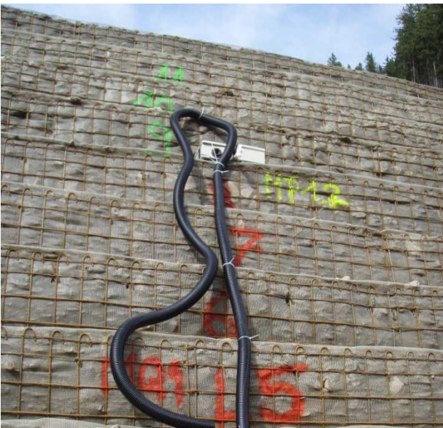
Abbildung 123: links: Anbringen Blick auf die Wandfläche; rechts: Kabelkasten zur Sammlung aller Leitungen eines Querschnitts
