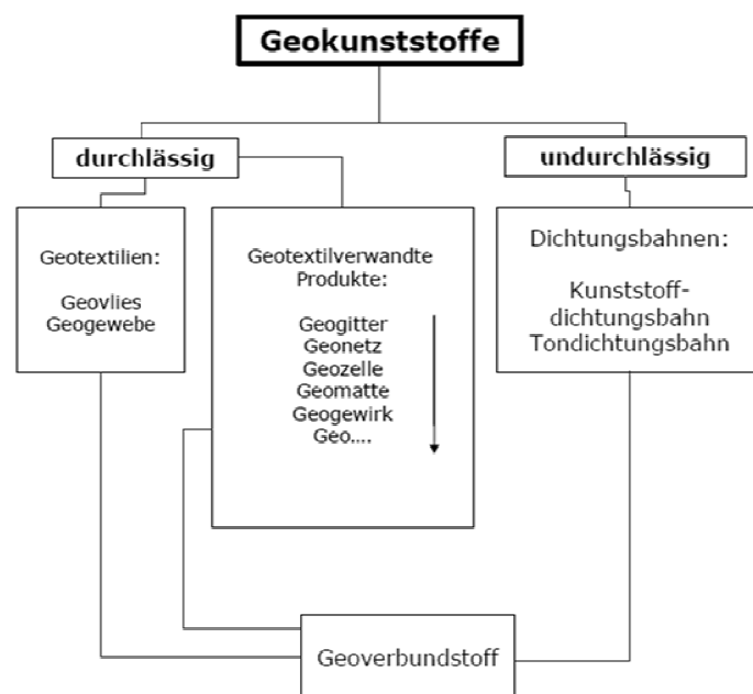
Abbildung 11: Einteilung der Geokunststoffe (Oberreiter, 2012)
