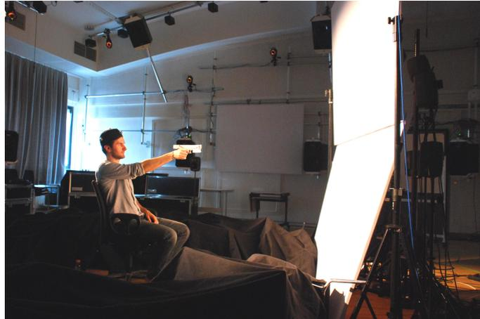
**Abbildung 4.4:** Bestimmung der Haupthörereignisrichtung mittels Spielzeugpistole.
