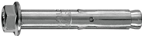
Abb. 2.9 Hülseanker - wegkontrolliert spreizender Dübel mit untenliegendem Konus [35]
