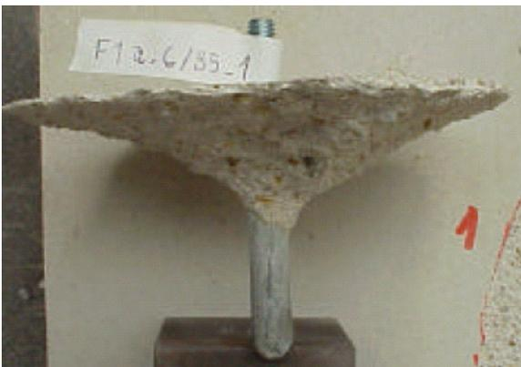
Abb. 3.6 Injektionsdübel nach kombiniertem Versagen in Vollsteinen. [18]
