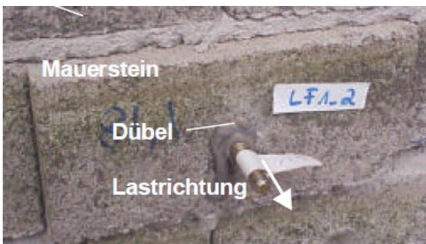
Abb. 3.9 Steinauszug eines Vollsteines aus dem Mauerwerksverband [23]
