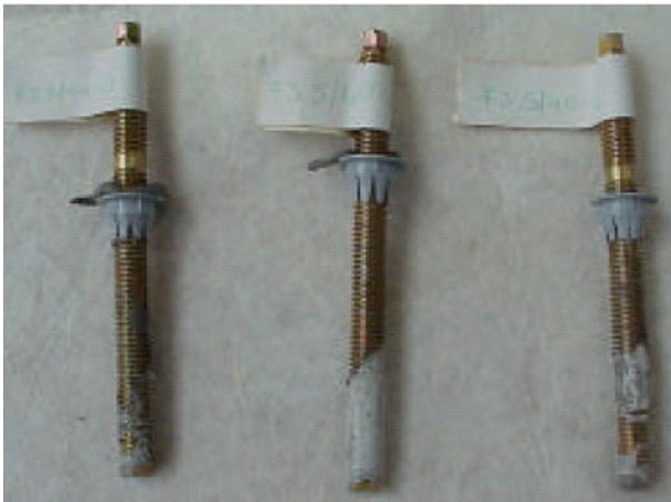
Abb. 3.4 Ankerstangen nach Verbundversagen zwischen Ankerstange und Mörtel. [23]
