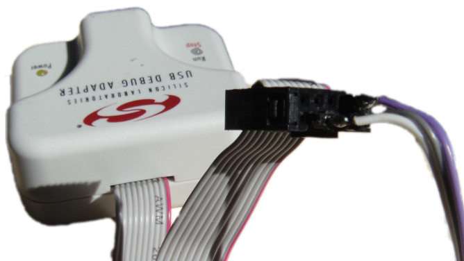
Abbildung 2.15: Silabs Debug Adapter
