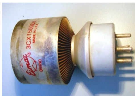
Abbildung 11: Die Hochleistungstriode der Optima 3000 XL
