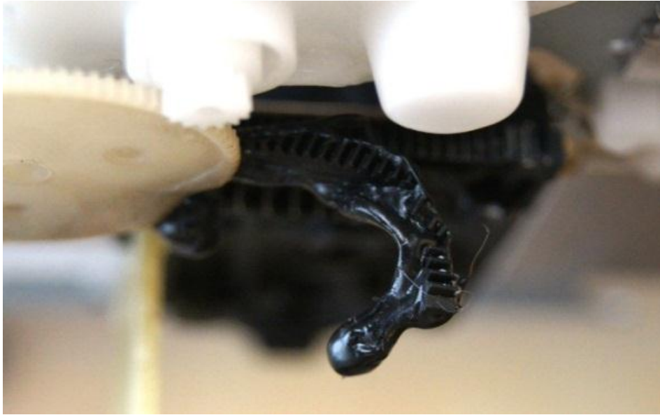
Abbildung 36: Der geschmolzene Transportschlitten
