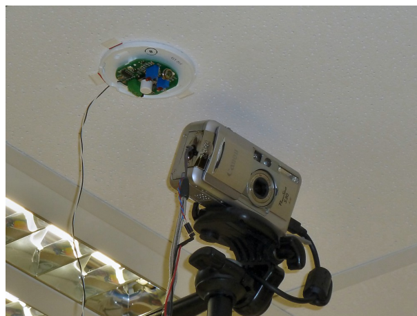
Abbildung 24: LSD-Lichtsensord neben der Kamera für die Referenzmessung
