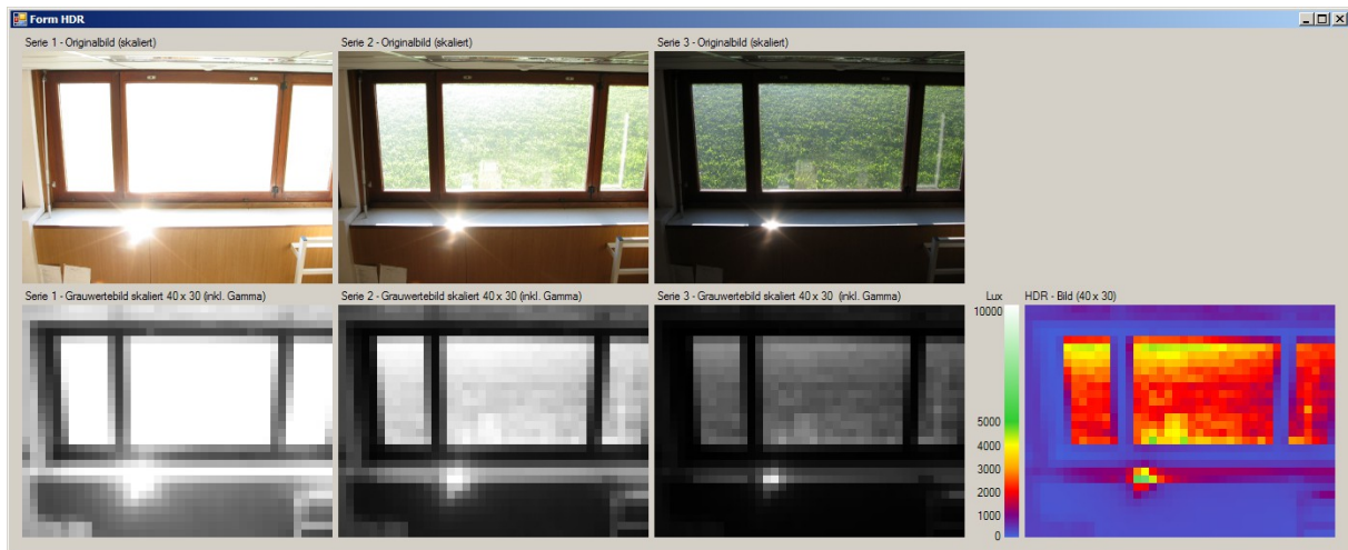
Abbildung 33: Spiegelung an der Fensterbank (ca. 16:00): Übersteuerung einzelner Pixel
