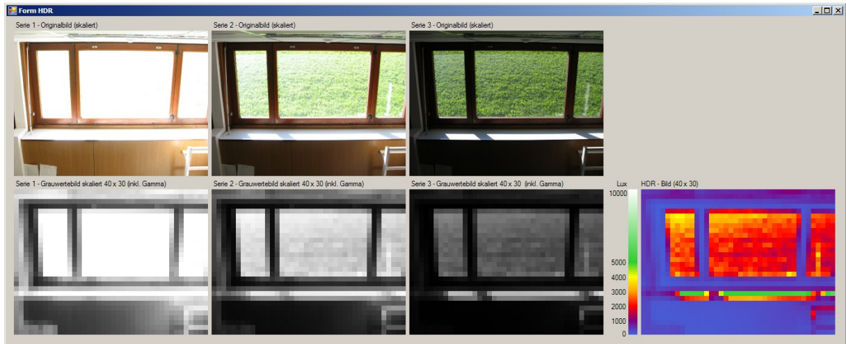
Abbildung 29: HDR-Bildberechnung oben: Belichtungsreihe der Szene; unten: linearisierte und skalierte Helligkeitsbilder sowie fertiges HDR-Bild
