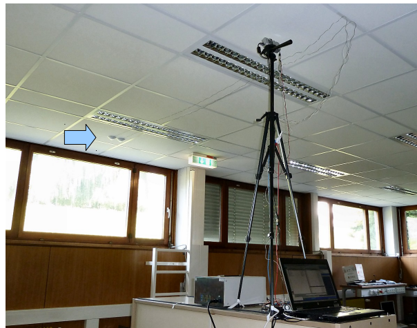
Abbildung 23: Messaufbau - Lichtmessung mit Kamera Der Pfeil markiert die LSD-Lichtsensoren oberhalb des Fensters
