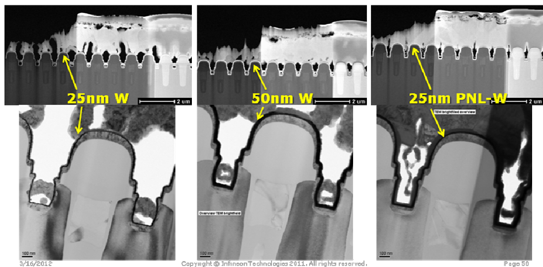
Abbildung 4–14: Gegenüberstellung von TEM-Analysen der Grabenstrukturen bei Barrieredicken von 25 nm W, 50 nm W und 25 nm PNL-W.
