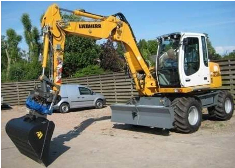
Abbildung 6.11: Hydraulikbagger auf Räder (Liebherr A 309) für Hebearbeiten bei Geokunststoffverlegung (77)
