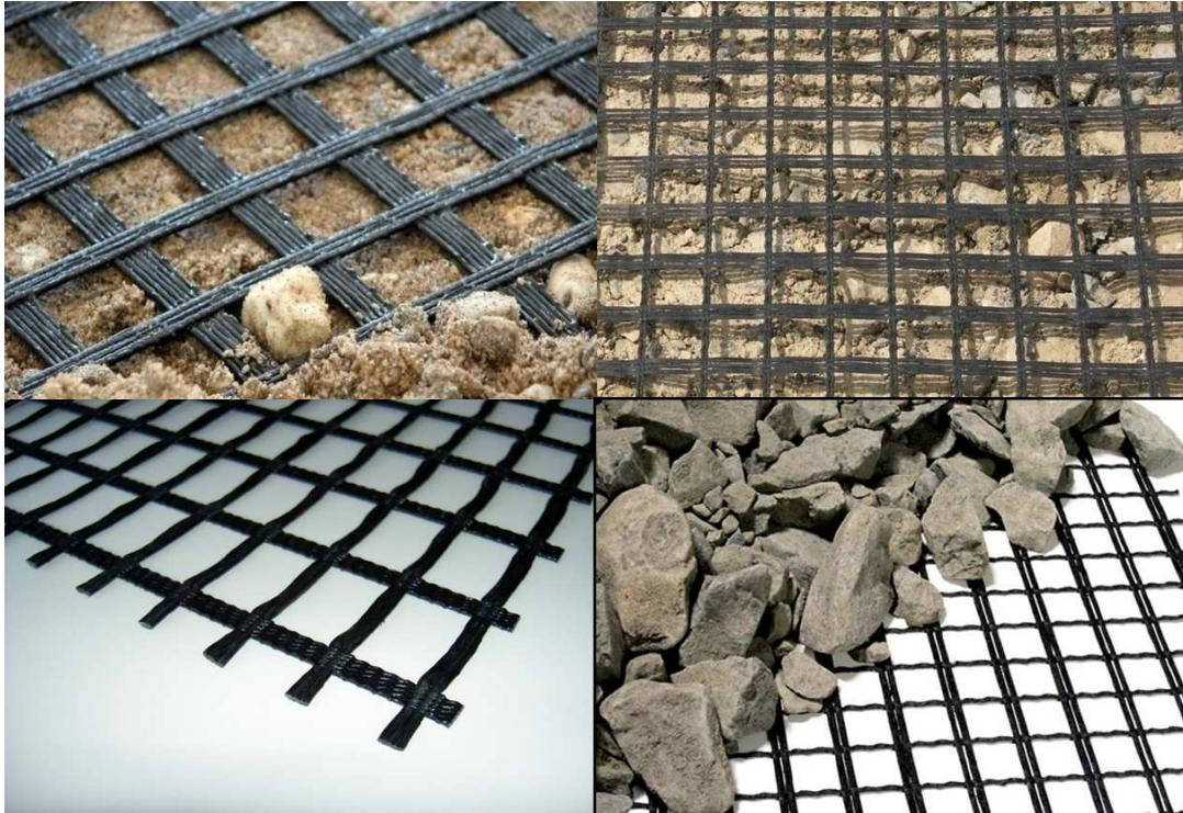
Abbildung 2.4: Beispiele von unterschiedlichen Geogittern (58)(59)(60)
