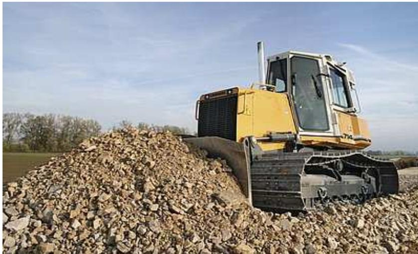
Abbildung 6.7: Planierraupe (Liebherr PR 714) für Einbau Schüttmaterial Bodenauswechslung (75)
