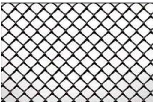
Abbildung 2.5: Beispiel eines Geonetzes (61)
