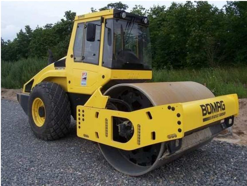
Abbildung 6.9: Walzenzug (Bomag BW 211) für Verdichtungsarbeiten (76)
