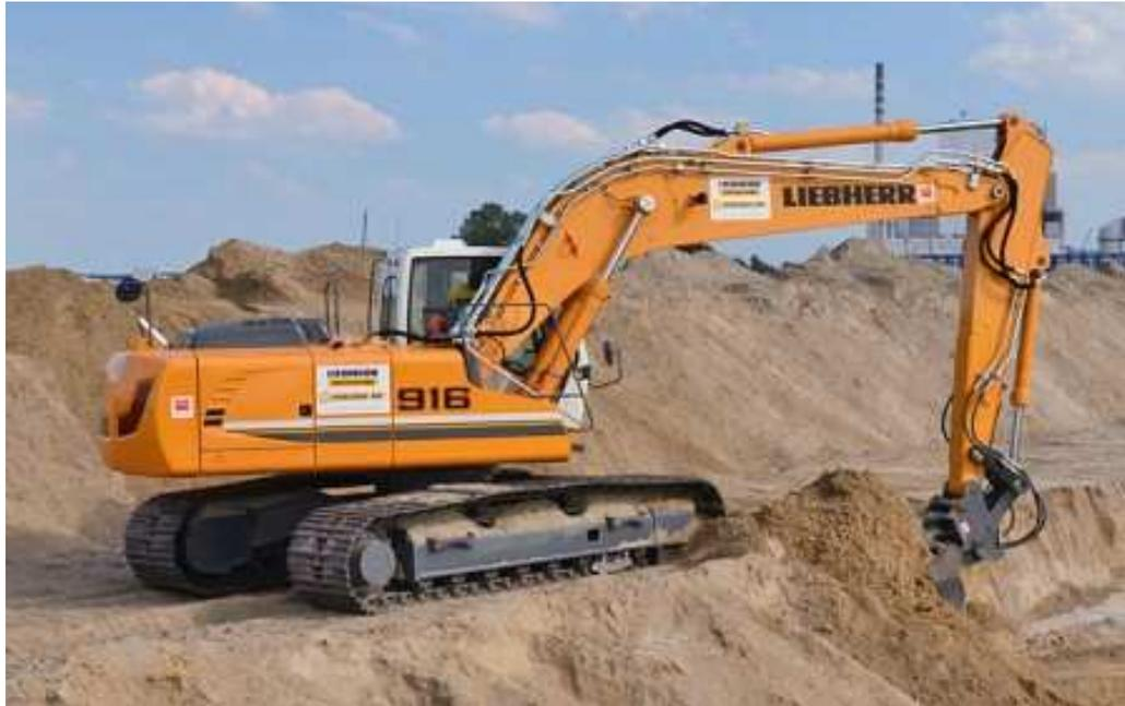
Abbildung 6.3: Hydraulikbagger (Liebherr R916) für Abtrag und Laden der Bodenauswechslung (73)
