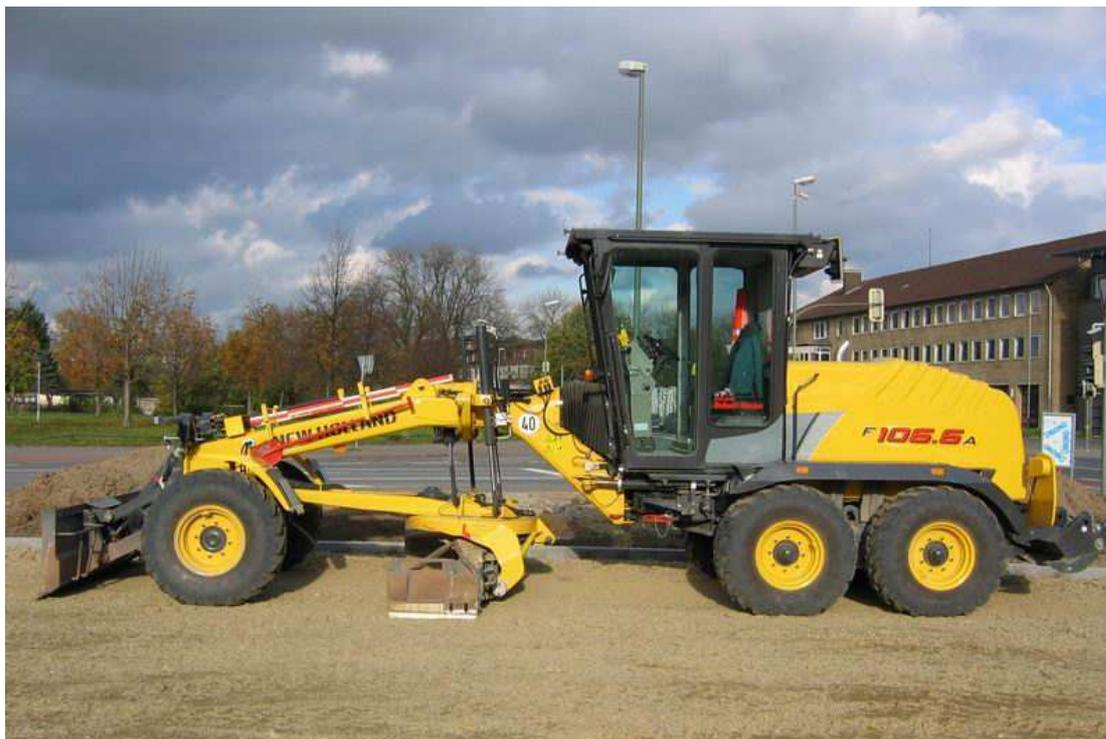
Abbildung 6.28: Grader für Einbau der ungebundenen Tragschichten (New Holland F106.6A) (79)
