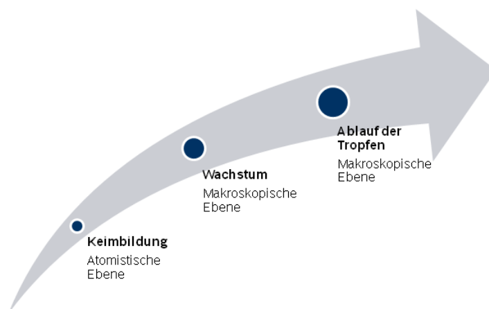
Abbildung 2-4: Tropfenkondensation als zyklischer Prozess
