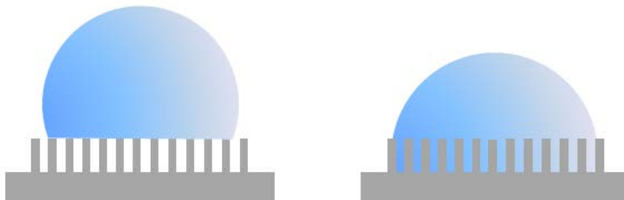
Abbildung 2-8: Benetzungsmodelle; links: Cassie-Baxter; rechts: Wenzel (nach [18])
