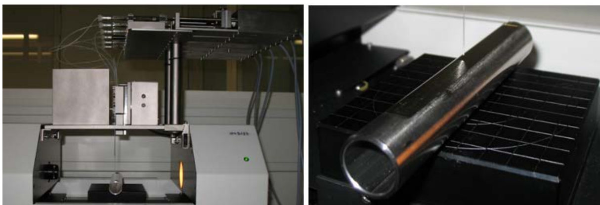
Abbildung 3-8: Kontaktwinkelmessung; links: XY-Tisch mit Dosiereinheit, rechts: Aufbringung eines Tropfens mit der Mikroliterspritze
