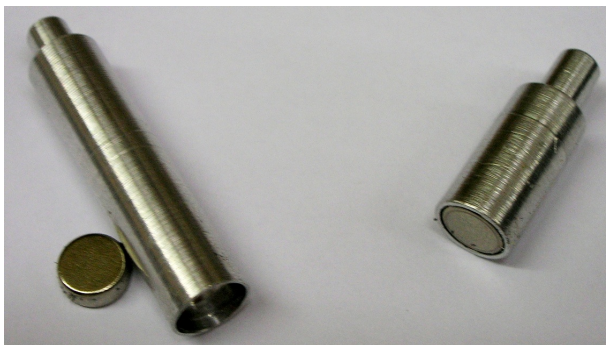
Abbildung 4.44: Magnethalter aus Aluminium
