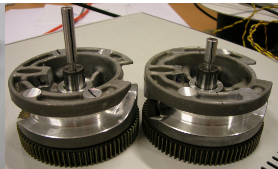
Abbildung 4.45: Magnethalter bei der Montage in die Schaltwalzenwellen
