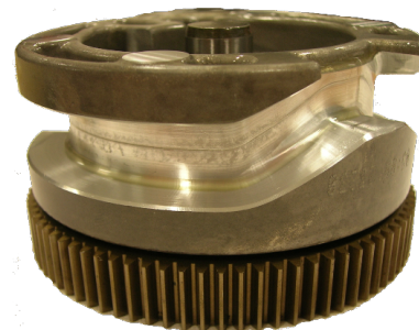
Abbildung 2.6: Schaltwalze mit umlaufender Nut des 6DCT250-Getriebes
