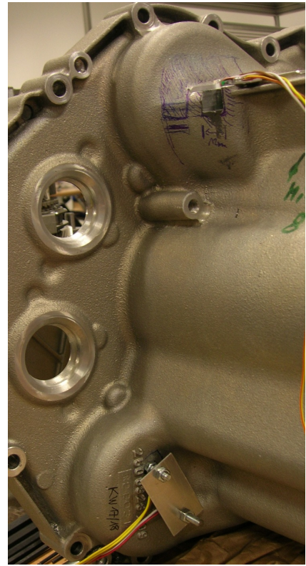
Abbildung 4.49: Fertig montierte Sensoren
