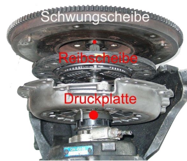
Abbildung 3.20: Aufbau einer manuellen Kupplung (Internetquelle: [25])
