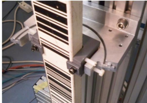
Abbildung 5: Verwendete Halterung zu Montage der Nivellierlatte
