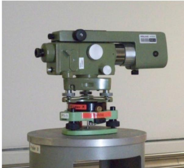
Abbildung 21: NA2 mit aufgesetztem Planplattenmikrometer GPM3
