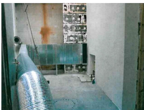
Abb. 4–6: Brandprüfung (normnah) mit Seitenwind 3 – Prüfaufbau [75]
