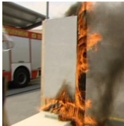
Abb. 2–25: Direkte Beflammung von EPS hinter der Deckschichte – Versuchsende [29]
