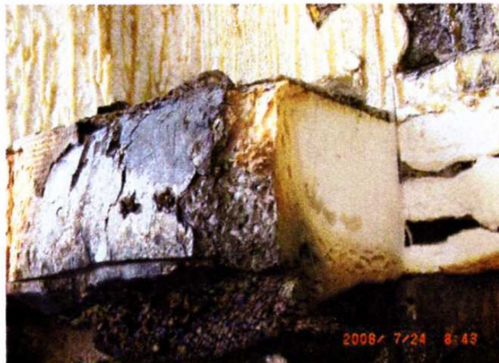
Abb. 4-32: Brandprüfung Sturzschutz aus Polyurethan 0,5m über dem Sturz [85]
