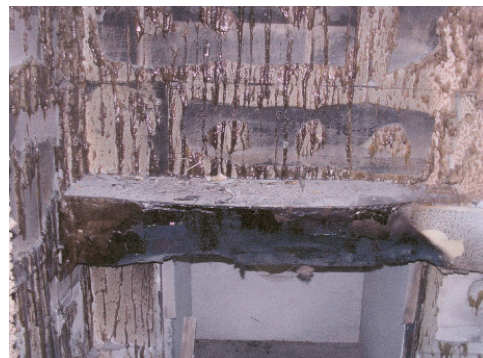
Abb. 4–17: Prüfung Sturzschutz aus Polyurethan – Fassadenschädigung [78]
