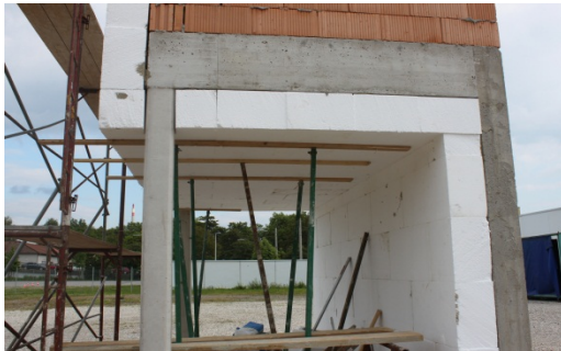
Abb. 4–12: Brandprüfung Untersicht Auskrägung - Prüfung
