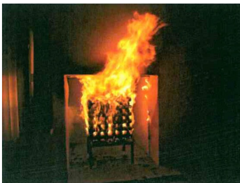
Abb. 4–7: Brandprüfung (normnah) mit Seitenwind 3- Prüfung [75]
