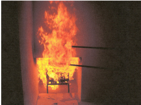
Abb. 4–19: Prüfung Sturzschutz aus Mineralwolle – Fassadenschädigung [79]
