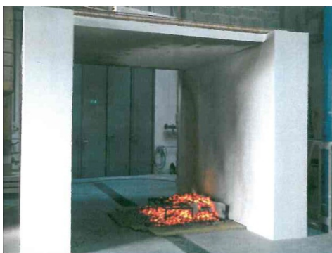
Abb. 4–9: Brandprüfung einer Durchfahrt 1 – Fassadenschädigung [54]
