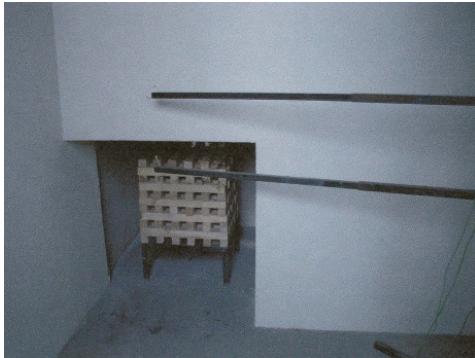
Abb. 4–16: Prüfung Sturzschutz aus Polyurethan – Prüfbeginn [78]
