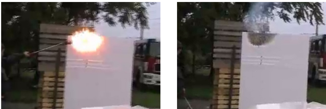
Abb. 2–22: Entflammungsversuch EPS mit Flammenschutzmittel [46]
