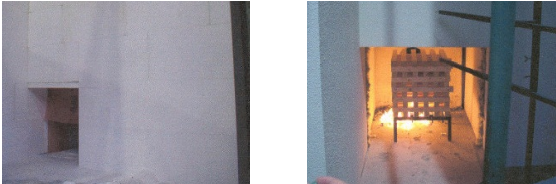
Abb. 4–20: Prüfung Sturzschutz aus Calciumsilikat – Prüfbeginn [80]
