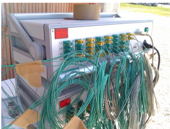
Abb. 3-5: Vorbereitung der Messtechnikstation vor der Brandprüfung
