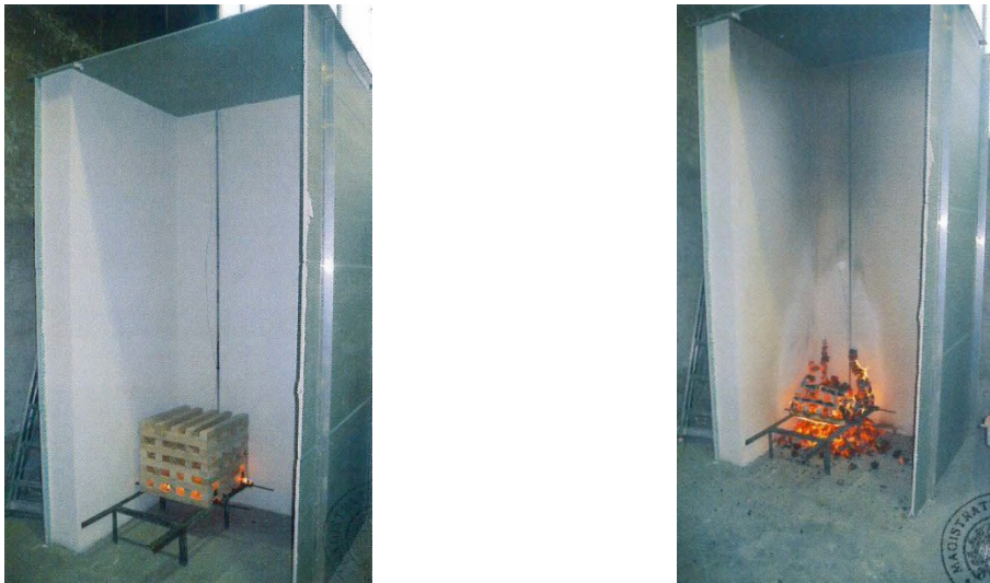
Abb. 4–30: Brandprüfung Loggia-Nische 2 – Fassadenschädigung [84]
