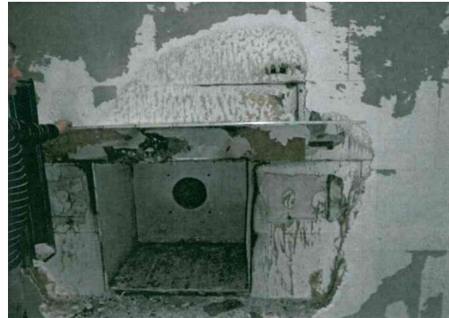
Abb. 4–3: Brandprüfung (normnah) mit Seitenwind 1 – Prüfung [75]
