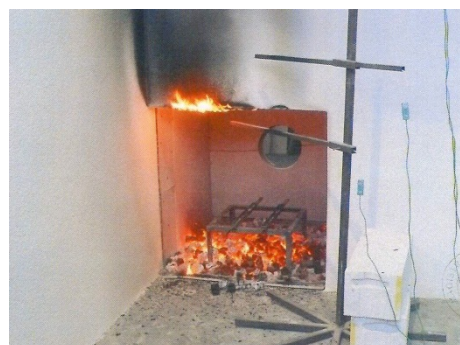
Abb. 4–25: Brandprüfung Armierungswinkel am Sturz – Polystyrolaustritt [82]
