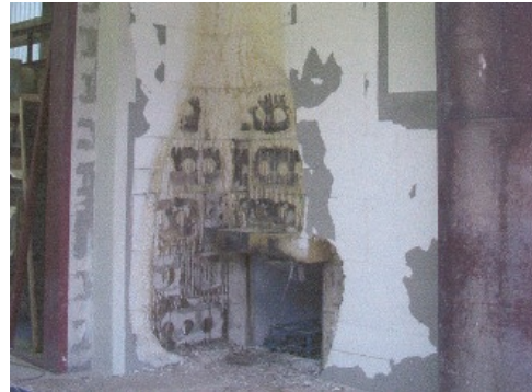
Abb. 4–19: Prüfung Sturzschutz aus Mineralwolle – Fassadenschädigung [79]
