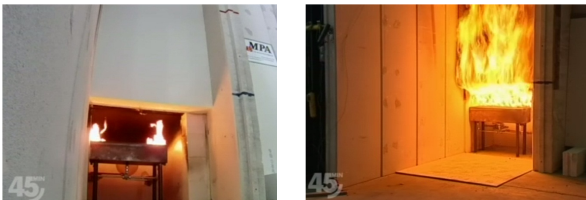
Abb. 2–27: Brandversuch WDVS ohne Sturzschutz – Brandeinwirkung [32]
