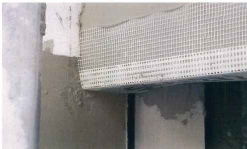
Abb. 4–24: Brandprüfung Armierungswinkel am Sturz – Prüfbeginn [82]
