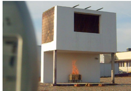
Abb. 4–12: Brandprüfung Untersicht Auskrägung - Prüfung
