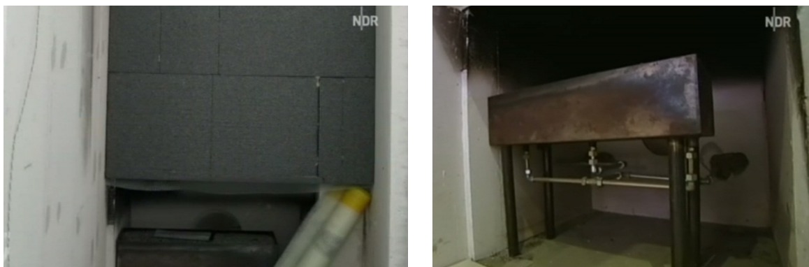
Abb. 2–26: Brandversuch WDVS ohne Sturzschutz – Versuchsaufbau [32]
