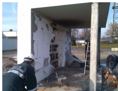
Abb. 4–13: Brandprüfung Untersicht Auskrägung – Fassadenschädigung
