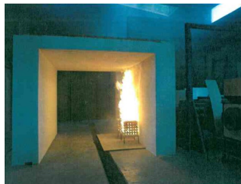
Abb. 4-10: Brandprüfung einer Durchfahrt 2 – Prüfung [76]
