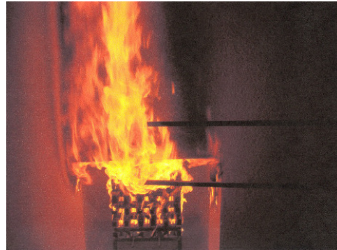
Abb. 4–16: Prüfung Sturzschutz aus Polyurethan – Prüfbeginn [78]
