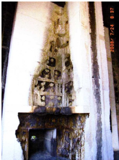
Abb. 4-32: Brandprüfung Sturzschutz aus Polyurethan 0,5m über dem Sturz [85]
