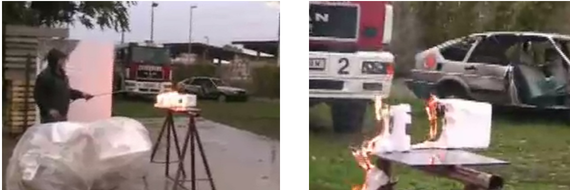
Abb. 2–23: Entflammungsversuch EPS ohne Flammenschutzmittel [46]
