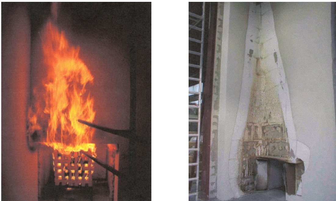
Abb. 4–21: Prüfung Sturzschutz aus Calciumsilikat – Fassadenschädigung [80]
