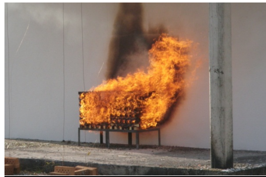
Abb. 6-2: Windmessung, Flammenauslenkung durch Seitenwind
