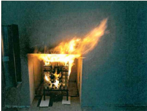
Abb. 4–3: Brandprüfung (normnah) mit Seitenwind 1 – Prüfung [75]
