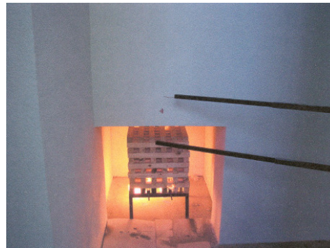
Abb. 4-18: Prüfung Sturzschutz aus Mineralwolle – Prüfbeginn [79]
