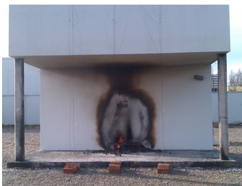
Abb. 4–13: Brandprüfung Untersicht Auskrägung – Fassadenschädigung
