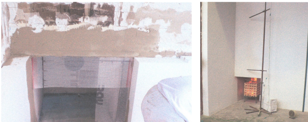
Abb. 4-27: Prüfung Sturzschutz aus Mineralwolle – Prüfbeginn [83]
