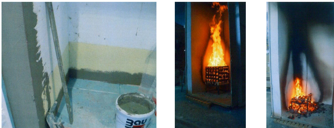
Abb. 4-31: Brandprüfung Loggia-Nische 3 – Fassadenschädigung [84]
