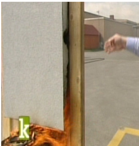
Abb. 2–25: Direkte Beflammung von EPS hinter der Deckschichte – Versuchsende [29]
