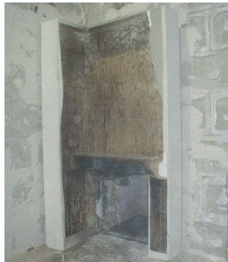
Abb. 4–23: Prüfung Sturzschutz aus Polyurethan – Fassadenschädigung [81]
