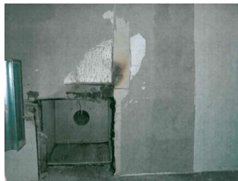
Abb. 4–7: Brandprüfung (normnah) mit Seitenwind 3- Prüfung [75]
