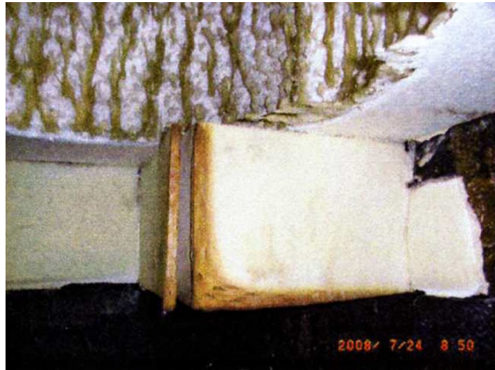
Abb. 4-33: Brandprüfung Sturzschutz aus Polyurethan 3,5m über dem Sturz [85]
