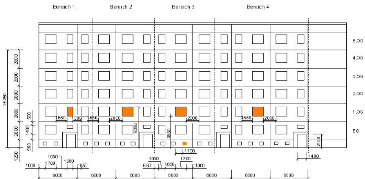
Abb. 2–18: Gebäudeskizze, Fensterpositionen [99, S27]
