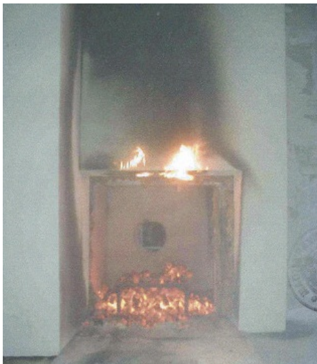
Abb. 4–23: Prüfung Sturzschutz aus Polyurethan – Fassadenschädigung [81]
