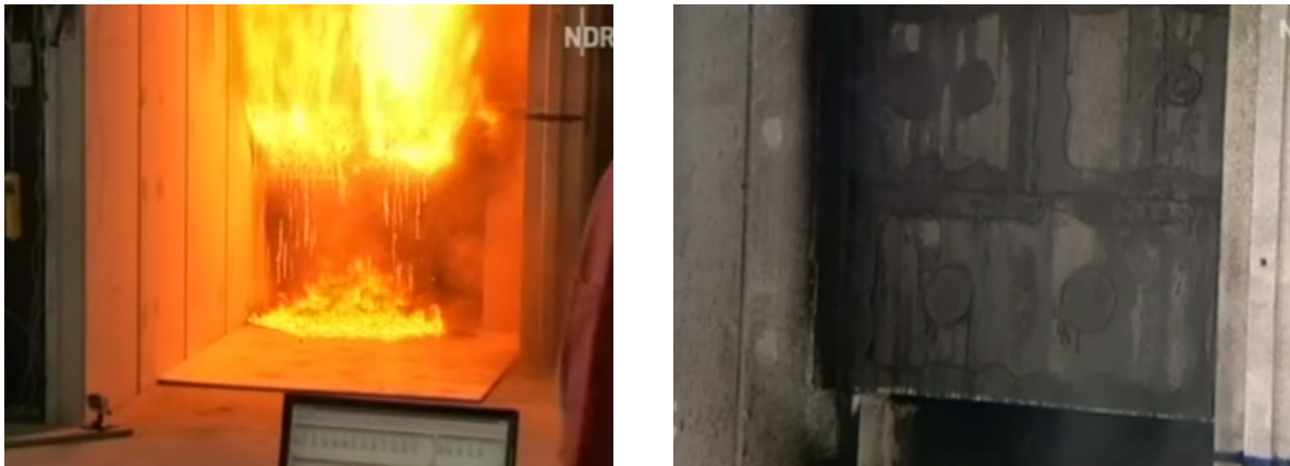
Abb. 2–28: Brandversuch WDVS ohne Sturzschutz – brennendes Abtropfen [32]
