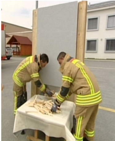
Abb. 2–24: Direkte Beflammung von EPS hinter der Deckschichte – Versuchsstart [29]
