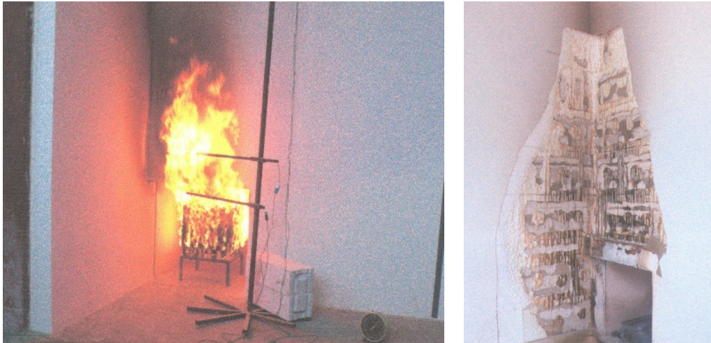
Abb. 4-28: Prüfung Sturzschutz aus Mineralwolle – Fassadenschädigung [83]
