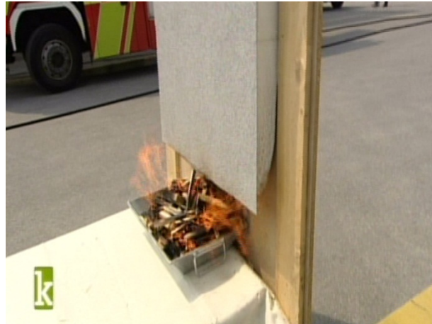
Abb. 2–24: Direkte Beflammung von EPS hinter der Deckschichte – Versuchsstart [29]
