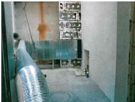
Abb. 4-2: Brandprüfung (normnah) mit Seitenwind 1 – Prüfaufbau [75]
