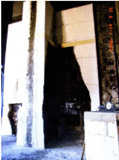
Abb. 4-33: Brandprüfung Sturzschutz aus Polyurethan 3,5m über dem Sturz [85]
