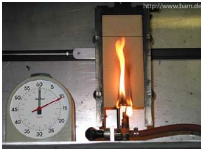
Abb. 3-2: Einzelflammentest gemäß EN ISO 11925-2 [58][59]
