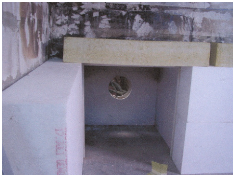
Abb. 4-18: Prüfung Sturzschutz aus Mineralwolle – Prüfbeginn [79]
