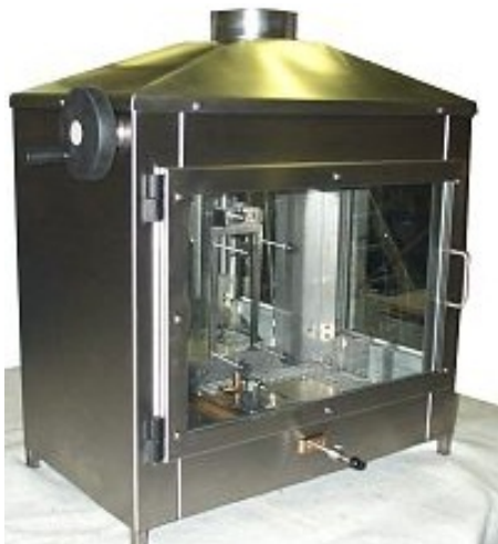
Abb. 3-2: Einzelflammentest gemäß EN ISO 11925-2 [58][59]
