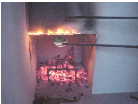
Abb. 4–17: Prüfung Sturzschutz aus Polyurethan – Fassadenschädigung [78]
