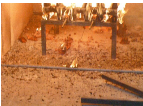
Abb. 4–25: Brandprüfung Armierungswinkel am Sturz – Polystyrolaustritt [82]
