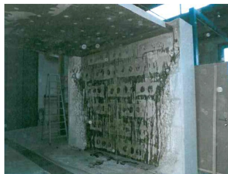
Abb. 4–9: Brandprüfung einer Durchfahrt 1 – Fassadenschädigung [54]
