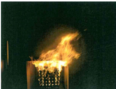
Abb. 4-5: Brandprüfung (normnah) mit Seitenwind 2 – Prüfung [75]
