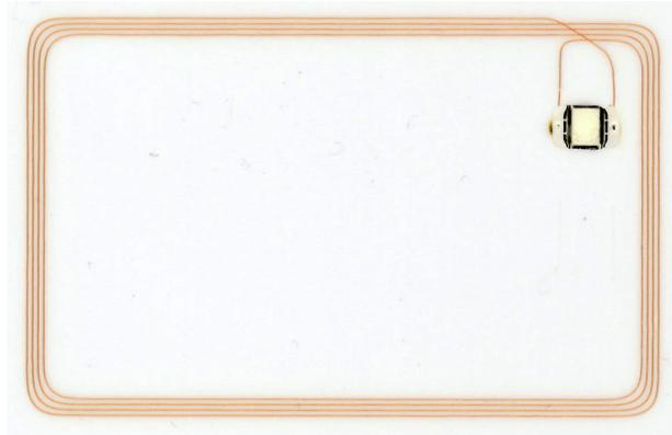
Abbildung 1.1: Aufbau einer kontaktlosen Smart Card.
