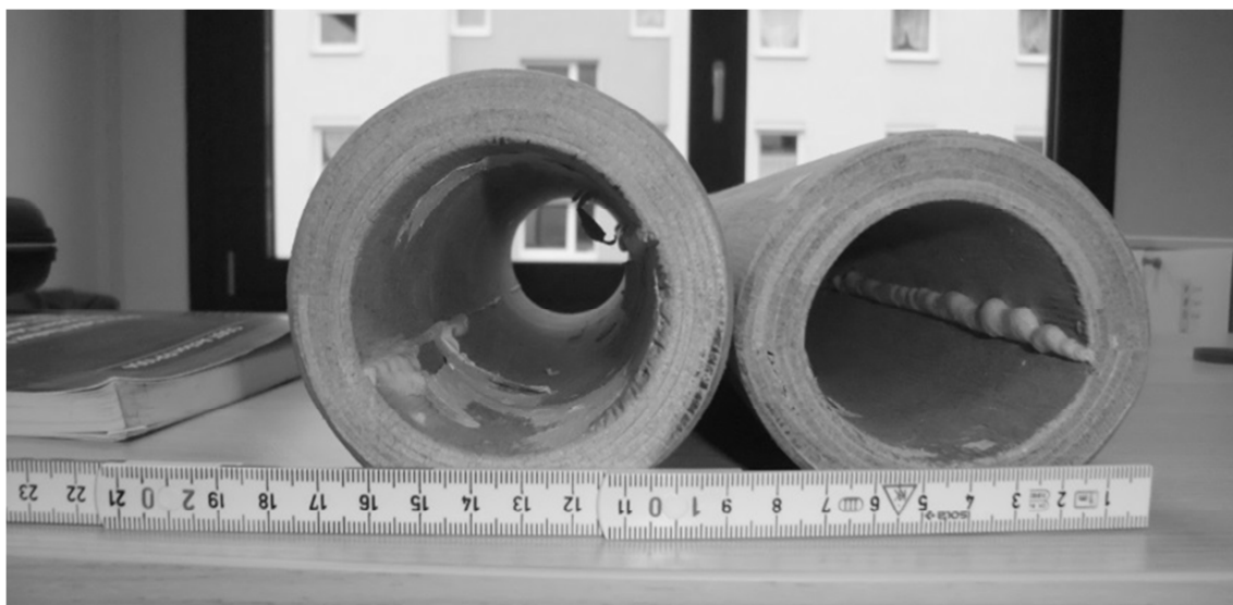
Abbildung 33: Furnierschichtholzrohre aus Buche [44]
