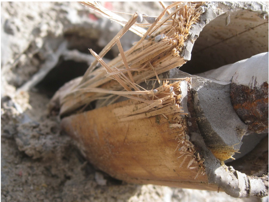
Abbildung 57: Entstandene Risse im Bambus und im Zementkörper
