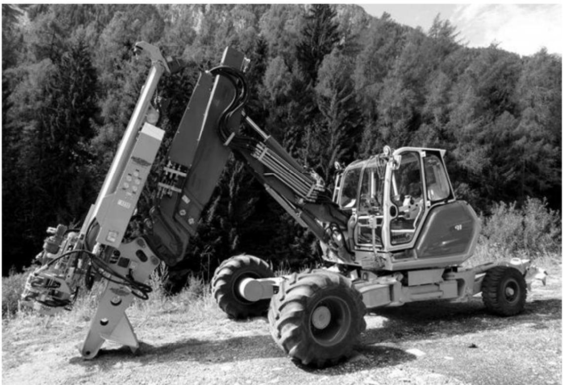
Abbildung 19: Menzi Muck mit Bohrlafette [25]
