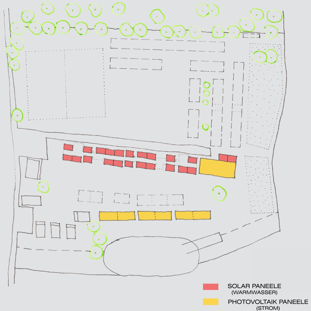
Bild_16: Solar und Photovoltaik Paneele am Grundstück
