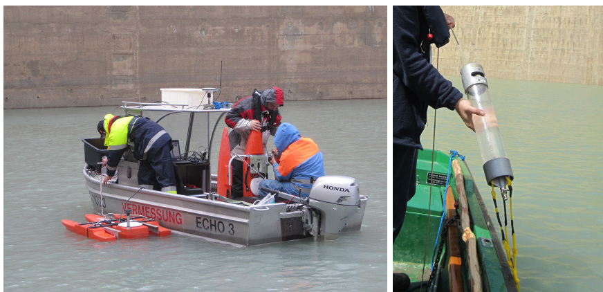
Abbildung 3.2: links: beide ADCP-Geräte, rechts: Schwebstoffprobennahme
