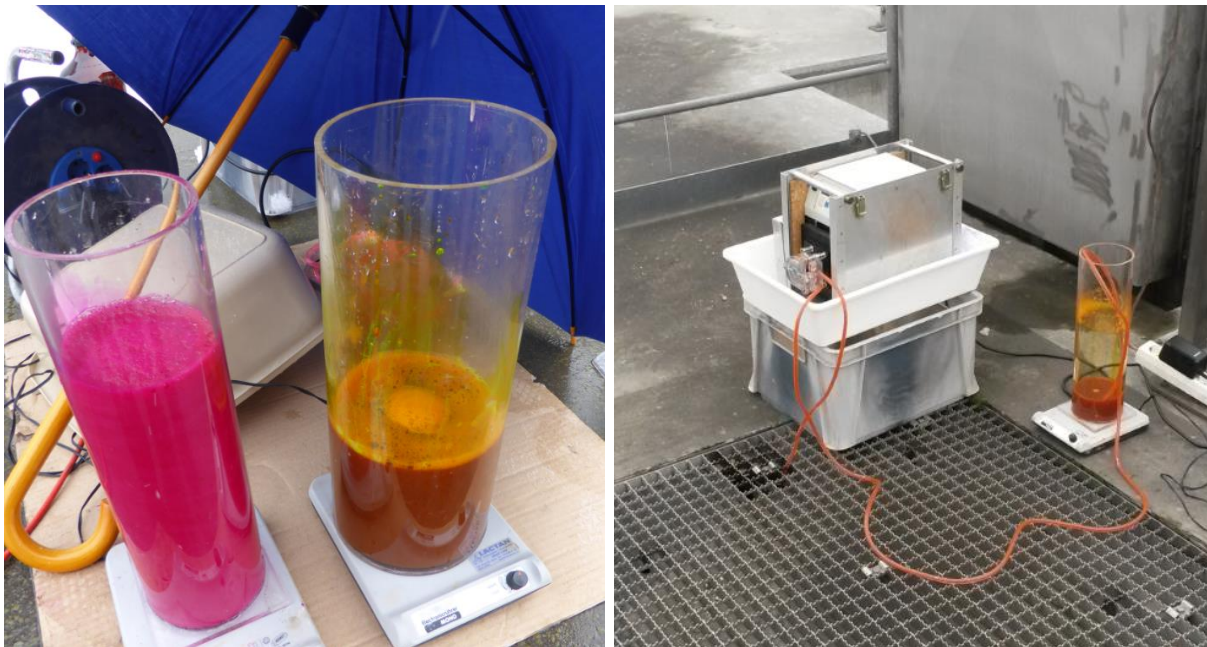
Abbildung 4-3: Tracer-Lösungen Rhodamin B (rot) und Uranin (gelb) auf Magnetrührer (links); Kontinuierliche Zugabe einer Uranin-Lösung während einer Tracermessung mit kontinuierlicher Zugabe (rechts).
