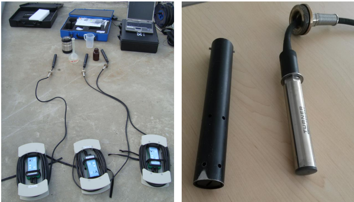
Abbildung 2-13: Drei Fluoreszenzmesssonden „TQ-Tracer“ mit Datenerfassungsgeräten „TQ-Amp“ und Kalibrierungsset (links) und Fluoreszenzmesssonde „TQ-Tracer“ inkl. Schutzhülle (rechts).
