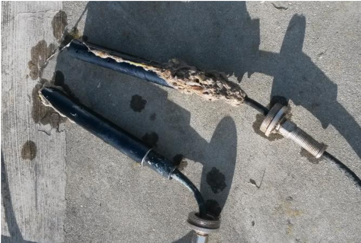
Abbildung 3-17: Verschmutzte und mit Abwasserinhaltsstoffen verstopfte Online-Tracersonden nach dem Messeinsatz in kommunalem Abwasser.
