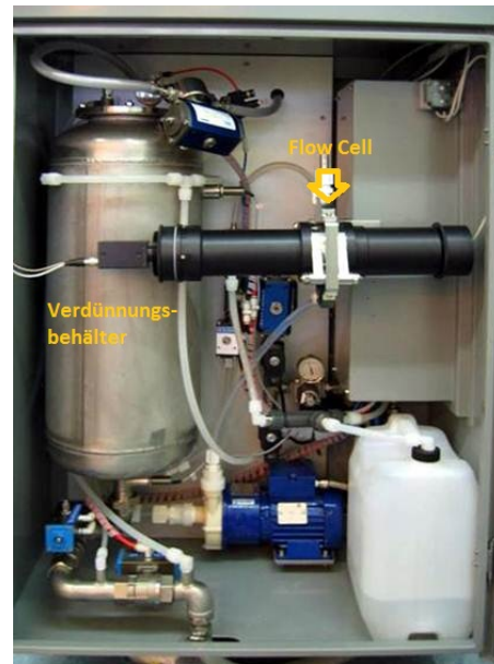
Abbildung 2.5: Das Faser und Splitter Modul des PulpExpert™
