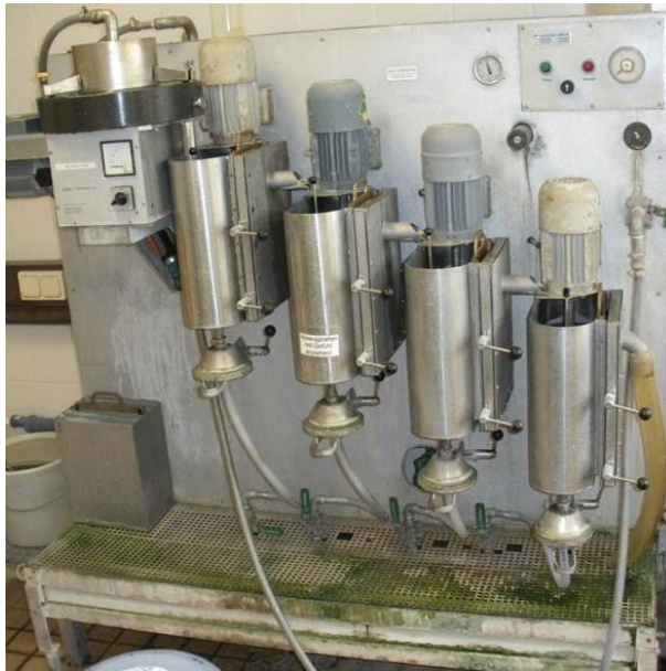
Abbildung 2.1: Bauer McNett Fraktioniergerät mit vorgeschalteter Haindl Splittersortierung
