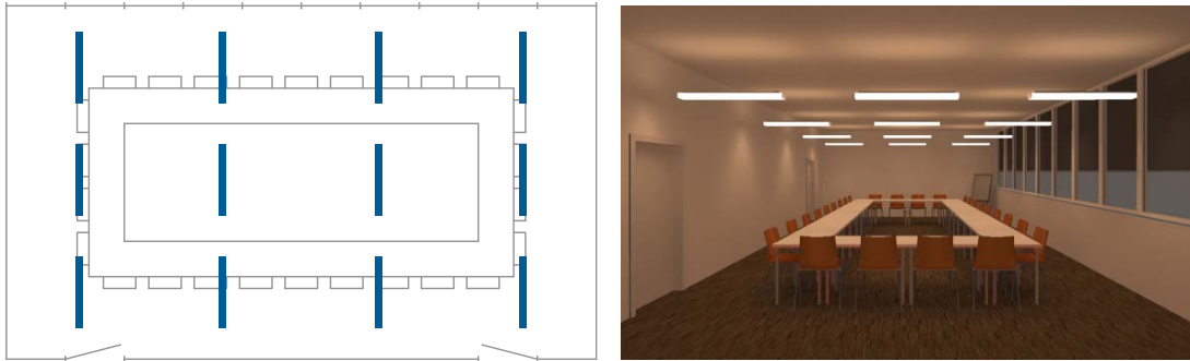
Anlage 4 – Struktur der Leuchtstoff - Pendelleuchten im Konferenzraum (Blockform)
