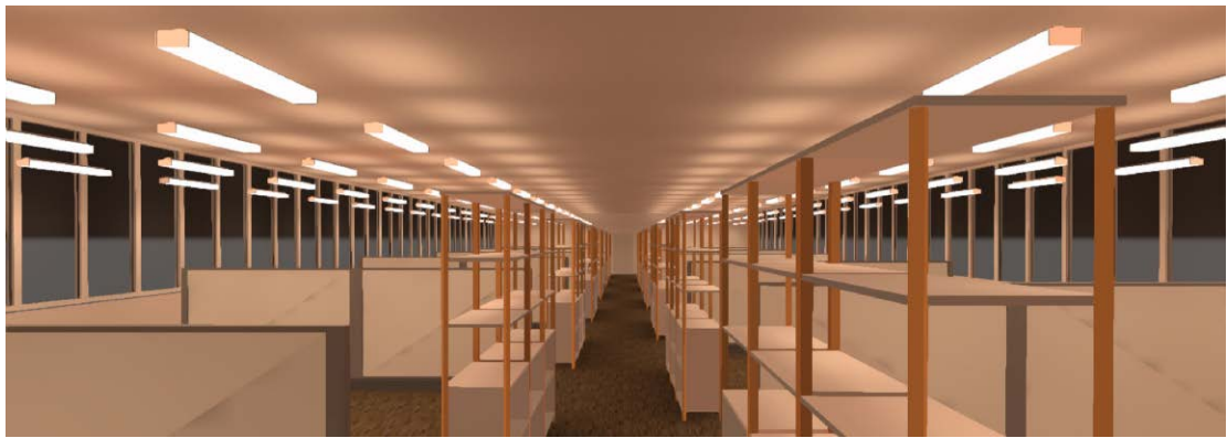
Abbildung 13 – Struktur der LED - Pendelleuchten im Großraumbüro
