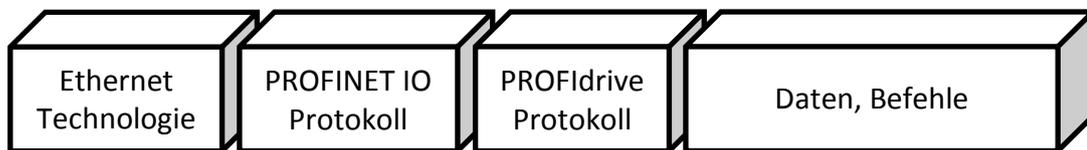
Abb. 4-1: Schematischer Aufbau — Kommunikation mit dem elektrischen Antrieb
