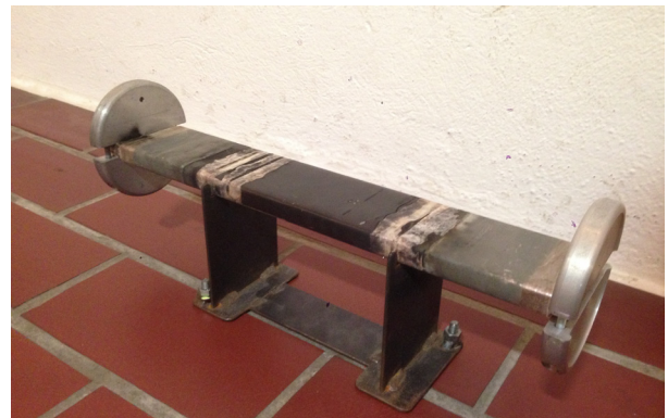
Bild 6-29: Generatorstab I nach 24 h (Unterseite)
