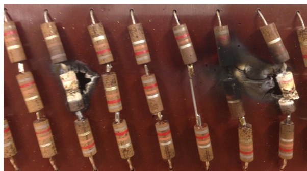
Bild 6-27: Widerstand R_4 nach dem Belastungstest
