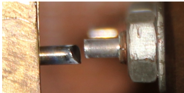
Bild 6-26: Elektrode der rotierenden Funkenstrecke nach dem Belastungstest
