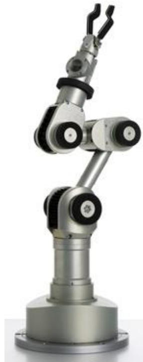
Figure A.3.: The Neuronics Katana 400 6m180 manipulator. The image is taken from http://www.openpr.de/news/229910/Quantensprung-Roboter-funktioniert-ohne-Computeranschluss.html .
