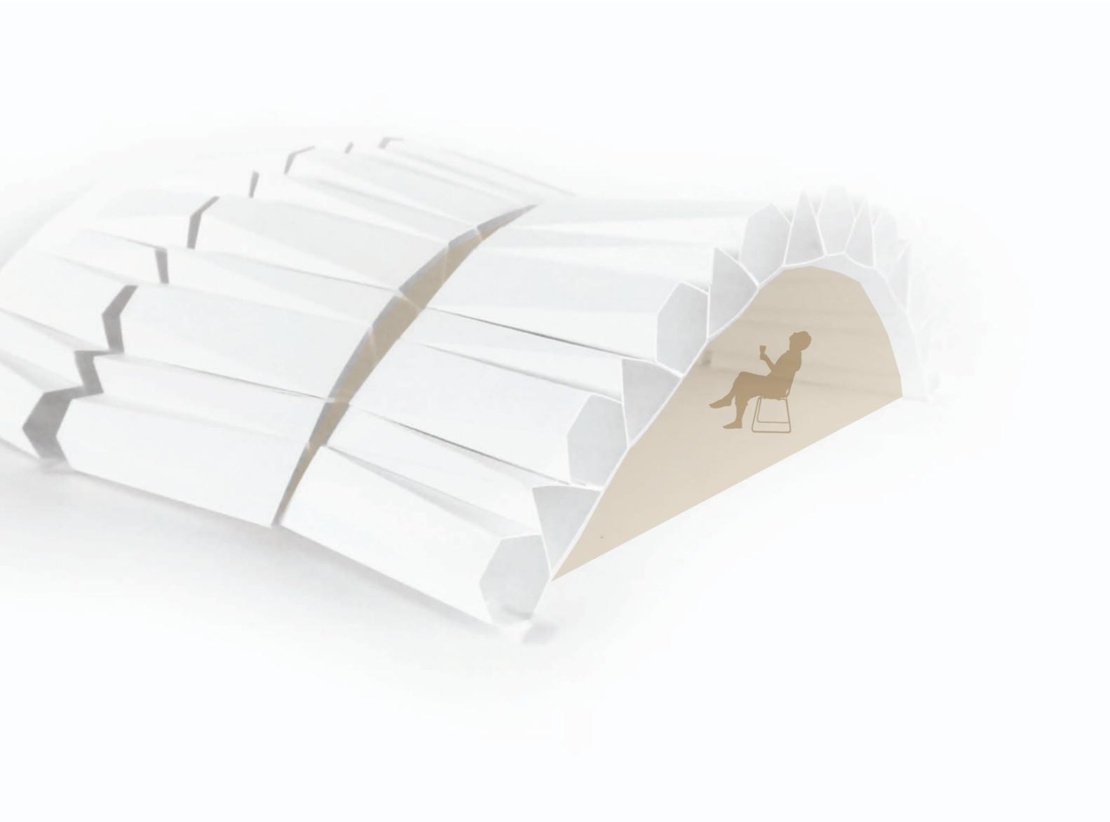
In Anbetracht der Architekturanwendung ist es natürlich wünschenswert, dass die **AUSDEHNUNG DER X-ACHSE** über die der verfügbaren Kartondimensionen hinausgeht. Eine Aneinanderreihung der Bogenelemente ist die logische Schlussfolgerung. Da die Geometrie der Bogenelemente eine konische Form beinhaltet, ist der direkte Anschluss nur durch Adaptierung der Schnittmuster möglich. Dies würde eine gewünschte Form voraussetzen, was jedoch nicht das Ziel jenes Systems ist.
