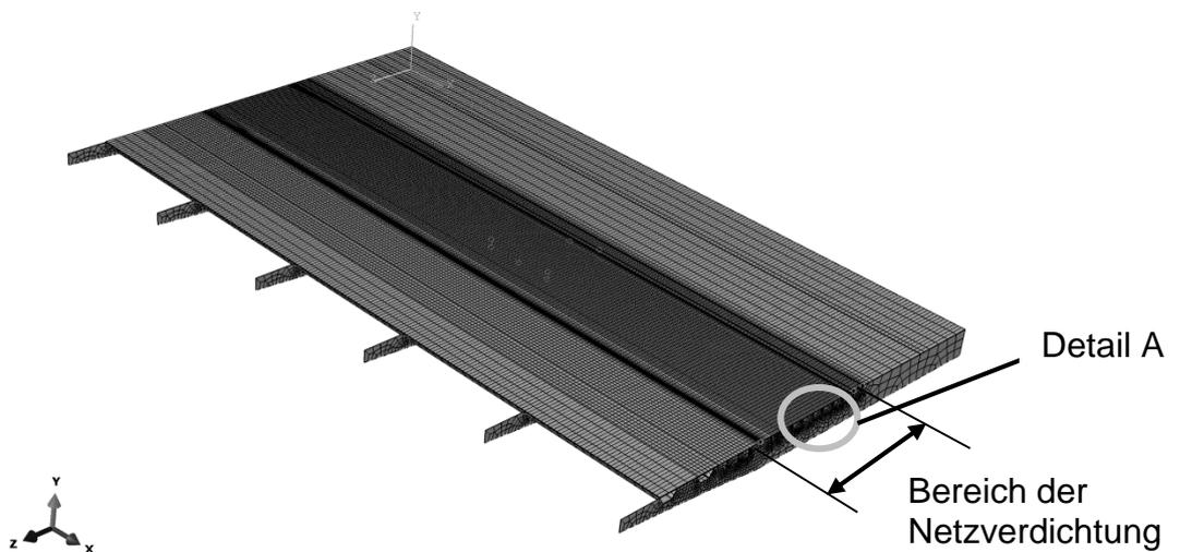
Abbildung 31: Diskretisierung des Deckbleches
