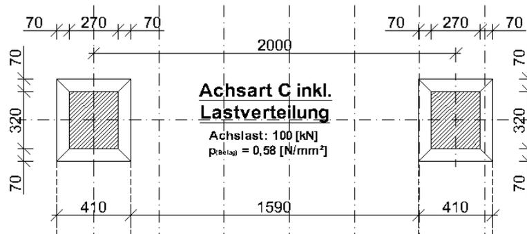
Abbildung 4: Achsart C mit lastverteilender Wirkung des Belags für Belagsdicke  $t_{\text{Bel}} = 70 \text{ [mm]}$
