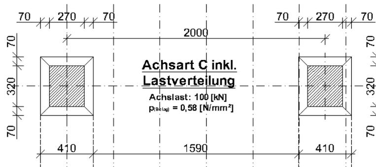
**Abbildung 56: Achsart C mit lastverteilender Wirkung des Belags**
