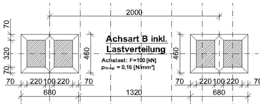
Abbildung 54: Achsart B mit lastverteiler Wirkung des Belages
