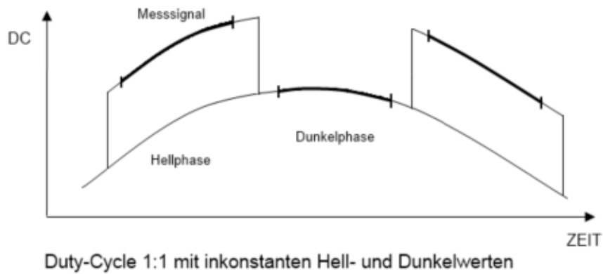
Abb. 2.11.: Veranschaulichung der Veränderung des Messsignals über die Zeit. Dargestellt ist ein Duty-Cycle anhand einer LED-Farbe. Das Messsignal reitet auf einer Welle, die durch die Bewegung des Anwenders und einer damit verbundenen Perfusionsänderung im Gewebe entsteht, die wiederum eine Änderung des Gleichanteils (DC) nach sich zieht.
