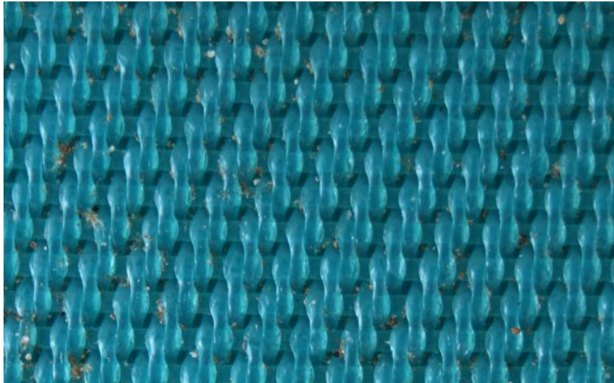
Abbildung 19: Anströmseite des PVDC-Versuchfiltergewebes; Versuchsdauer 6,5 [h]; 822 Rückspülungen; Feststoffkonzentration Zulauf:7,6 [mg/L]; 90 [m 3 ] erzeugtes Filtrat
