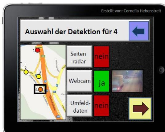
Wurden alle Detektoren eingegeben, werden alle ermittelnde Geräte auf einem Überprüfungs bild nochmals angezeigt. Es wird zusätzlich die Tafelnummer ausgegeben. Sollte die Karte als Kontrolle benötigt werden, kann auf das Feld „Karte“ geklickt werden.
