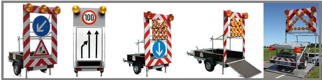
Abbildung 104: Fahrbare Absperr- und Vorwarntafeln
