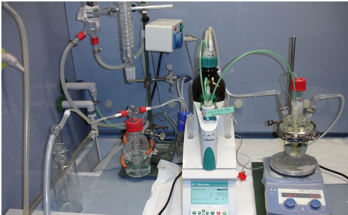
Abbildung 6 - Apparatur für die Cerimetrie
