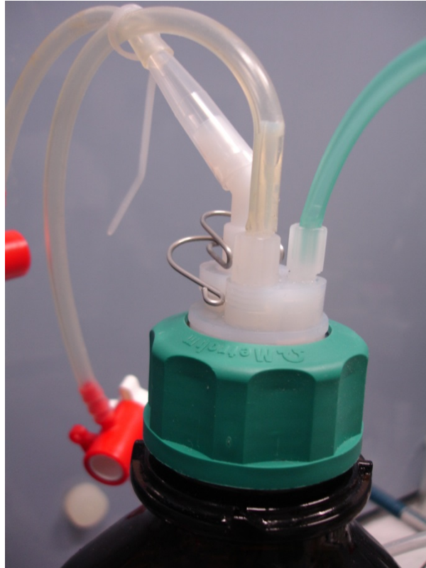
Abbildung 7 - Argon Zu- und Ableitung der Ammoniumeisen(II)-sulfatlösung
