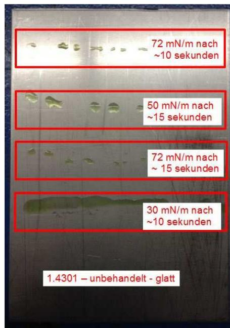
Abbildung 45: Benetzungstest, unbehandeltes 1.4301
