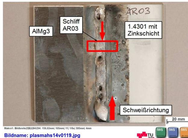
Abbildung 115: Probenentnahme Schweißung AR03
