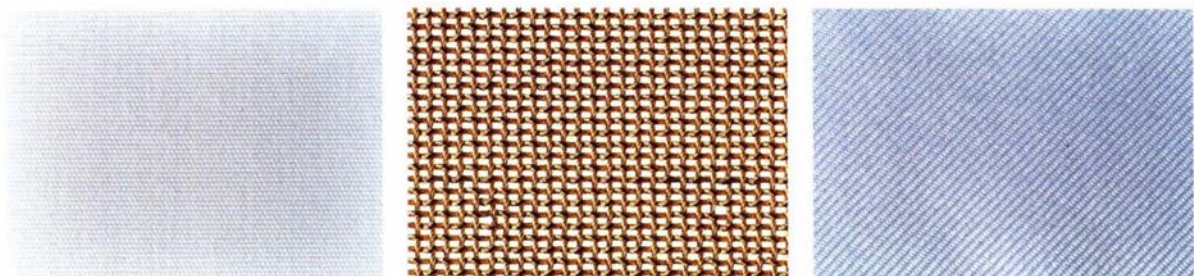
Abb. 2.9 Unbeschichtete Gewebe, links: Baumwollgewebe, mitte: Metallgewebe, rechts: PTFE-Gewebe [17]
