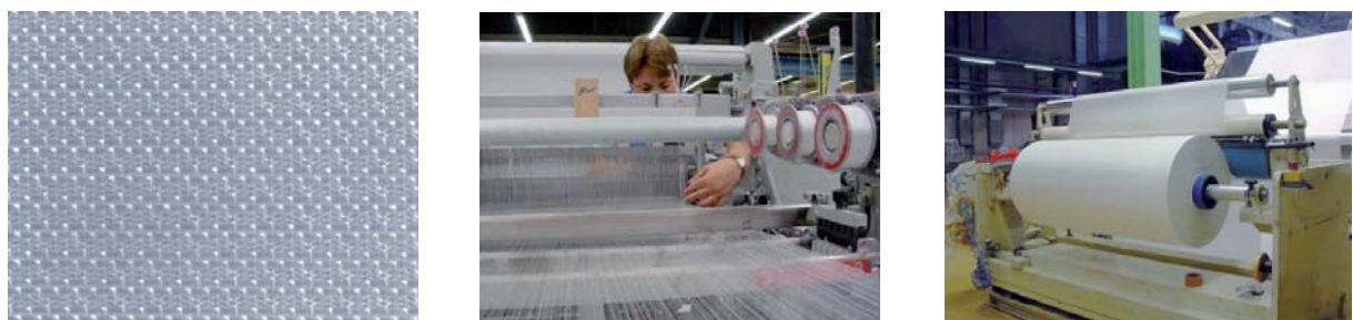
Abb. 2.13 links: silikonbeschichtetes Glasfasergewebe, mitte und rechts: Fertigung [22]
