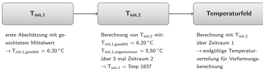
**Abbildung 3.4:** Ablauf der Temperaturfeldberechnung
