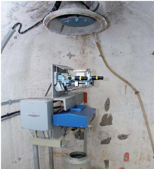
**Abbildung 2.6:** Hängelot – Messnische mit automatischer (unten) und manueller Ableseeinrichtung (oben)
