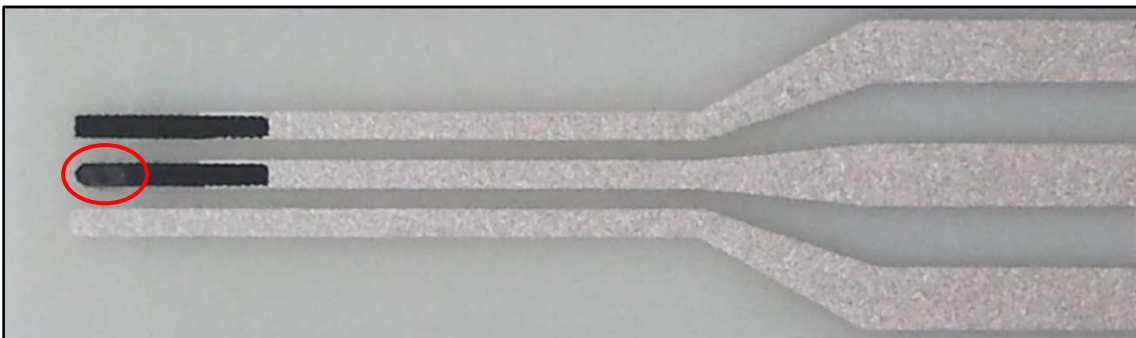
Abbildung 13: Schritt 3 bei der Sensorherstellung: Braunstein wird auf die Arbeitselektrode gedruckt (rot markiert)
