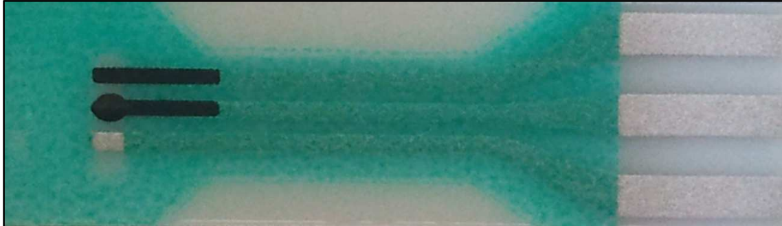
Abbildung 15: Herstellung eines Platinsensors: Statt Braunstein wird Platin auf die Arbeitselektrode dispensiert
