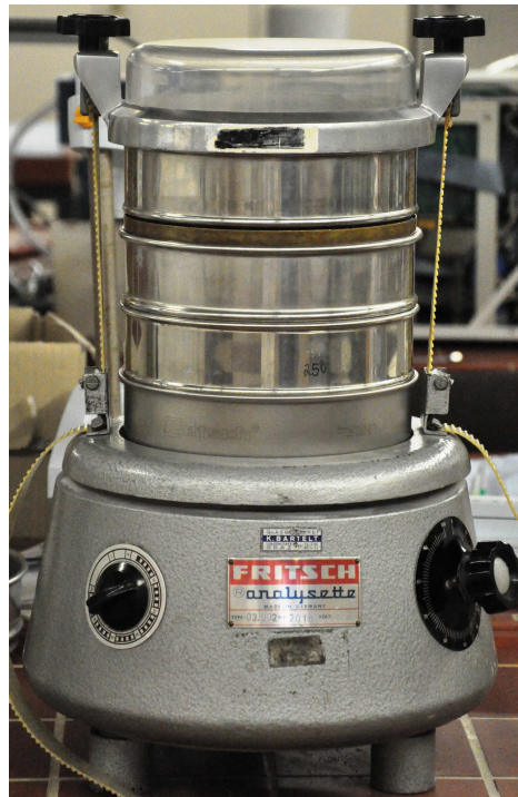
Abbildung 3.24: Der verwendete Siebturm mit den Sieben der Maschenweiten 250, 500 und 800 \mu\text{m}
