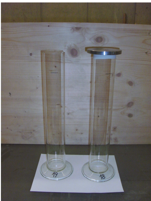
Abbildung 4.9: 1-Liter-Mensurzylinder mit den Innenabmessungen 340 x 62,5 mm
