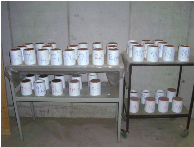
Abbildung 4.12: gelagerte SVM-Proben in Styroporschalungen
