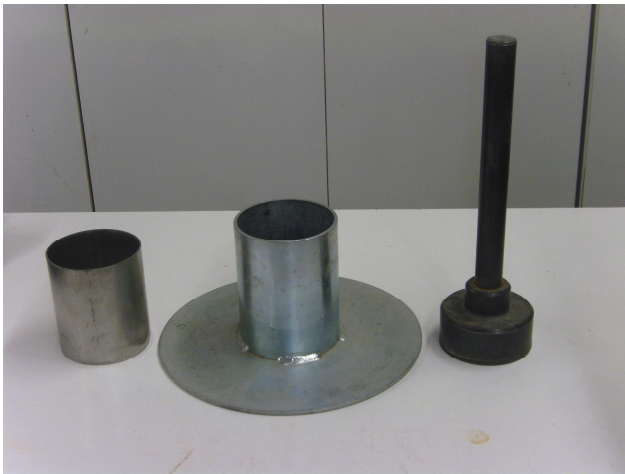
Abbildung 5.6: Stechzylinder (von links) mit Führungszylinder und Schlaghaube nach ÖNORM B 4401-1,1980
