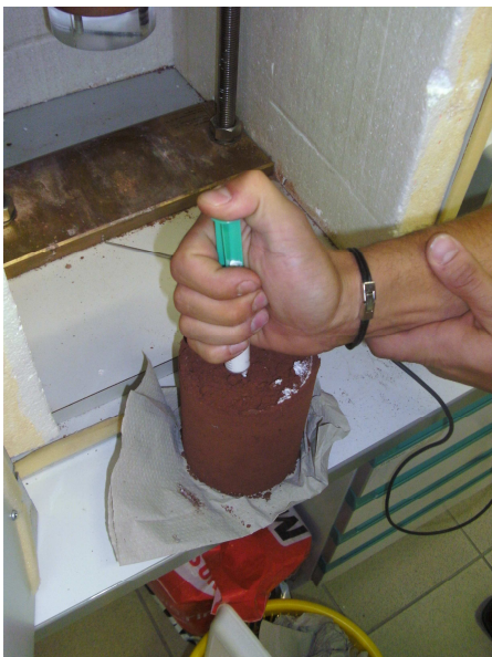
Abbildung 6.6: Einbringen der Wärmeleitcreme
