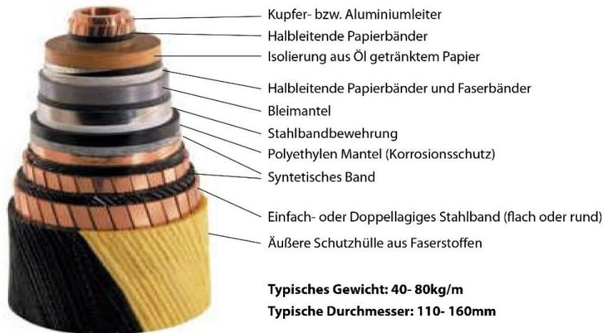
Abbildung 3: Aufbau eines Öl-Papier Kabels [ICC1]
