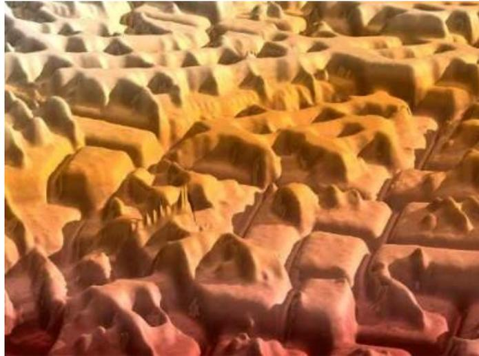
Abbildung 42: Aufnahme eines Elektronenrastertunnelmikroskops: Es handelt sich hierbei um eine Kupferoberfläche, die mit Stickstoff beschossen wurde [RTM2]
