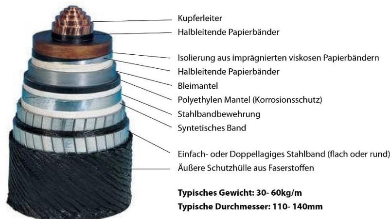
Abbildung 2: Aufbau eines Masse-imprägnierten Kabel [ICC1]
