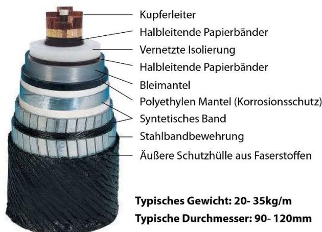
Abbildung 4: Aufbau eines vernetzten Polyethylen-Kabels [ICC1]
