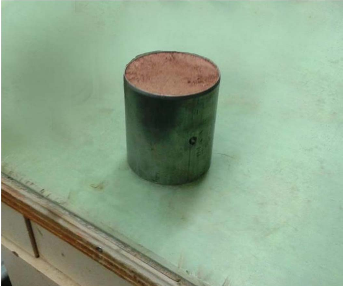
Abb. 18: Zylindrische Bodenprobe – Thermosand (06.05.2014)
