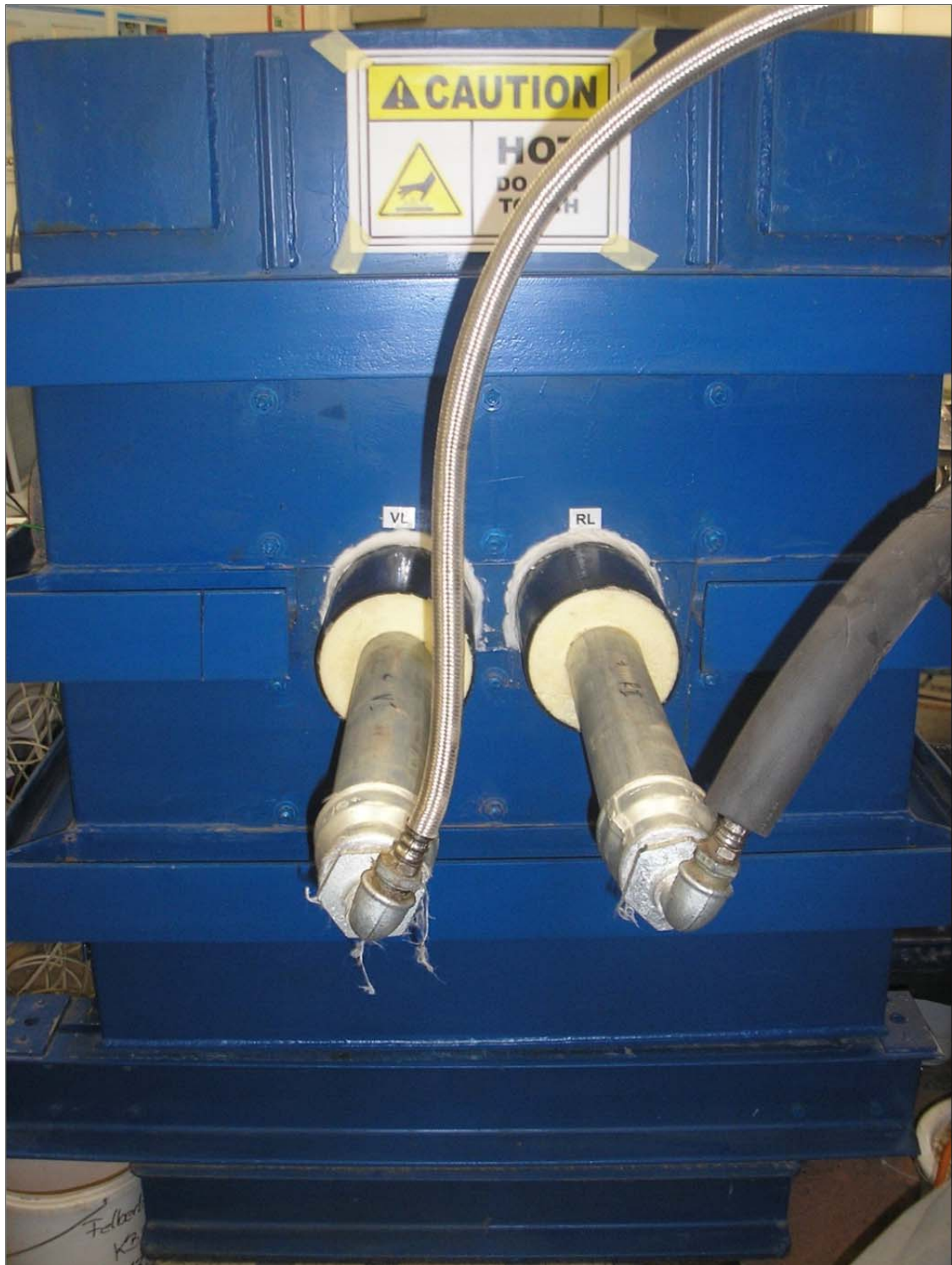
Abb. 29: Vorlauf und Rücklaufrohr des Modellversuchs (28.08.2014)
