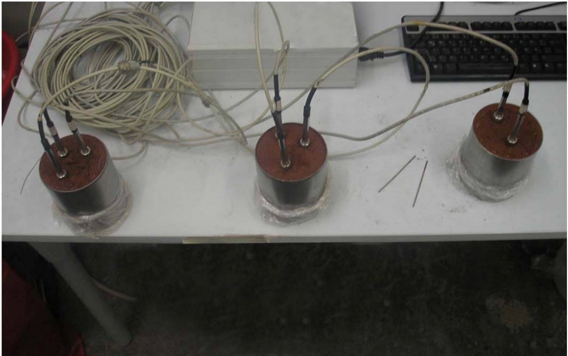
Abb. 20: Wassergehaltsmessung mittels TDR-Sonden in den Probenzylindern (28.05.2014)
