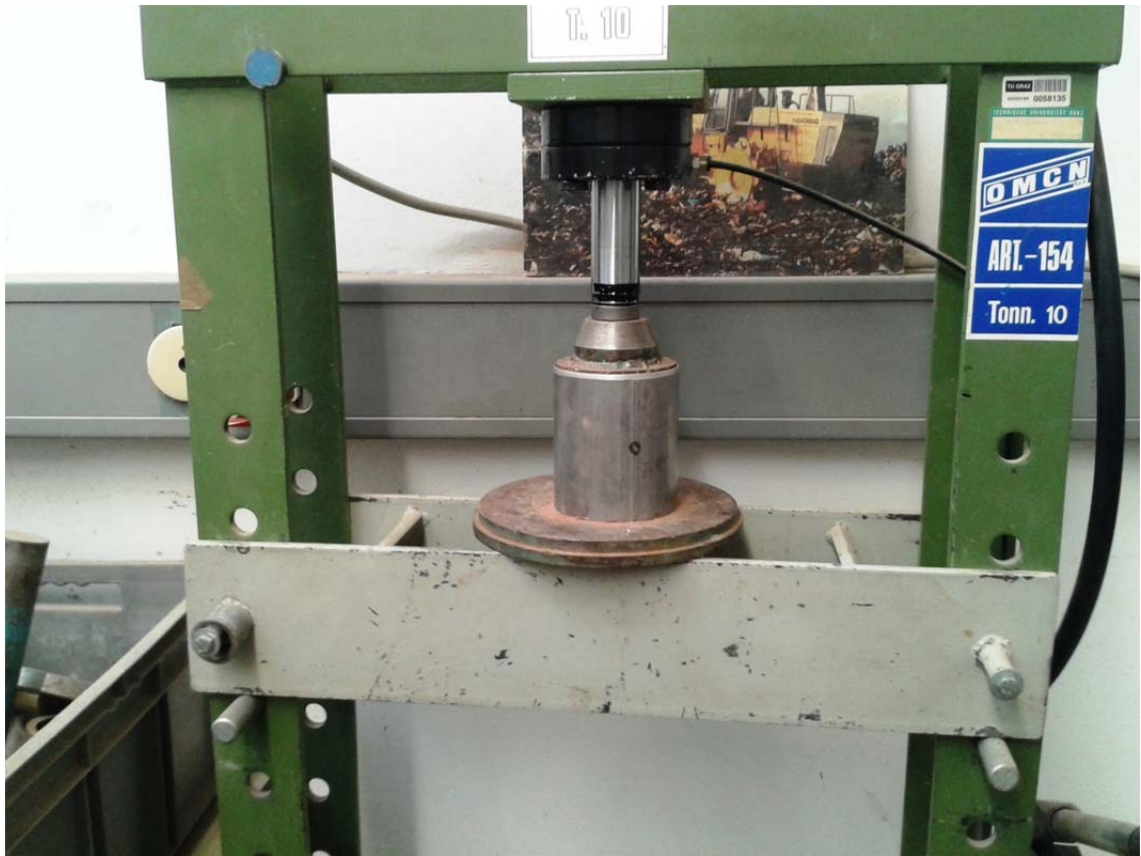
Abb. 19: Einpressen mittels einer hydraulischen Presse (06.05.2014)
