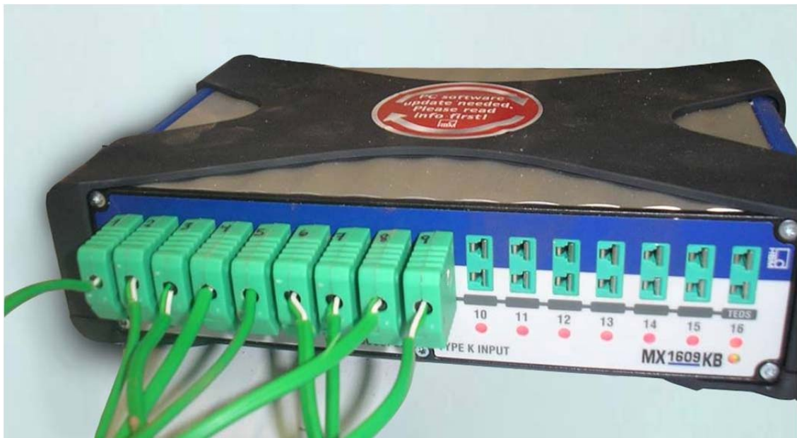
Abb. 15: QuantumX MX1609 Messverstärker mit den Thermoelementen des Typs K
