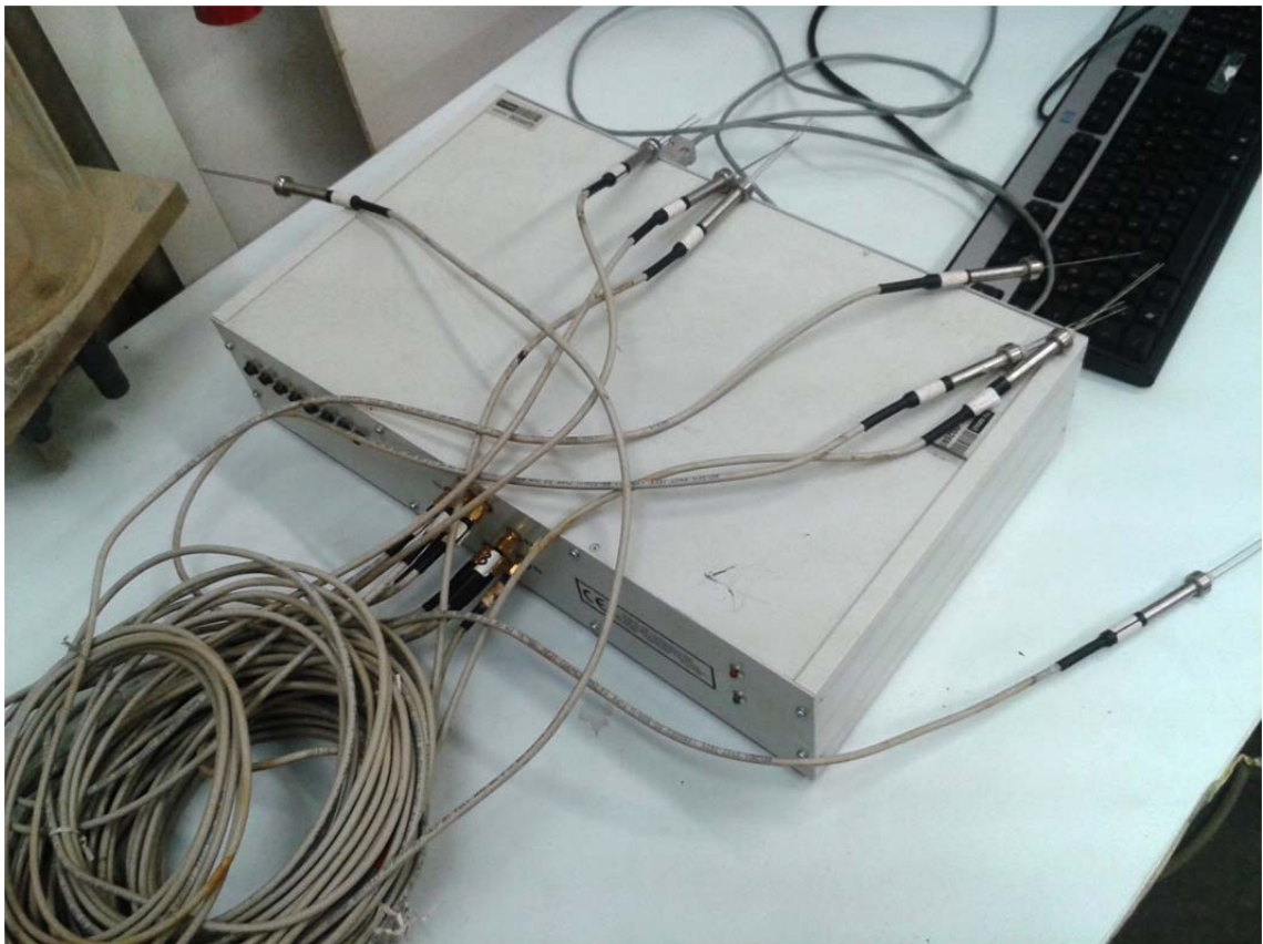
Abb. 17: PC-gesteuerte Datenerfassungseinheit LOM/8/mps (12.05.2014)
