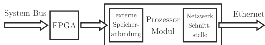
Abbildung 13: Prozessor Modul mit FPGA als Gateway für den System Bus
