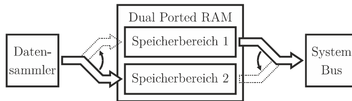
Abbildung 21: Schematische Darstellung des Puffers im „dual ported“ RAM
