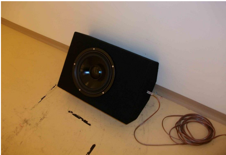
Abb. 3.3: Foto des konstruierten Lautsprechers.
