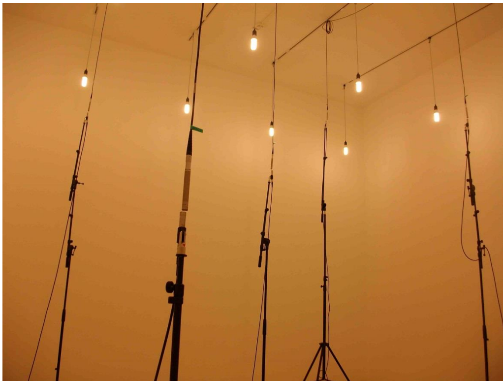
Abb. 6.14: Die Positionen der Mikrophone bei der ersten Hallraumprüfung.
