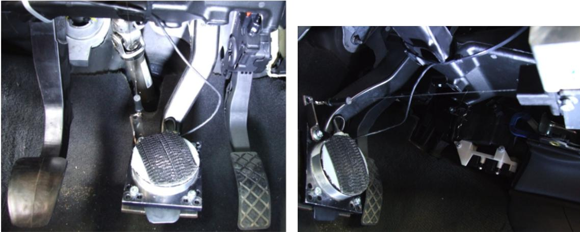
Abbildung 3.1: Aufbau Pedalwegmessung am FTG
