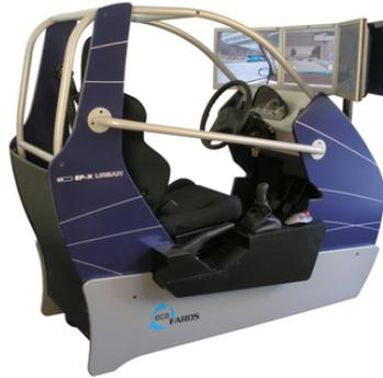
Abbildung 2.2: Fix Base Simulator der Firma ECA Faros, Quelle [9]
