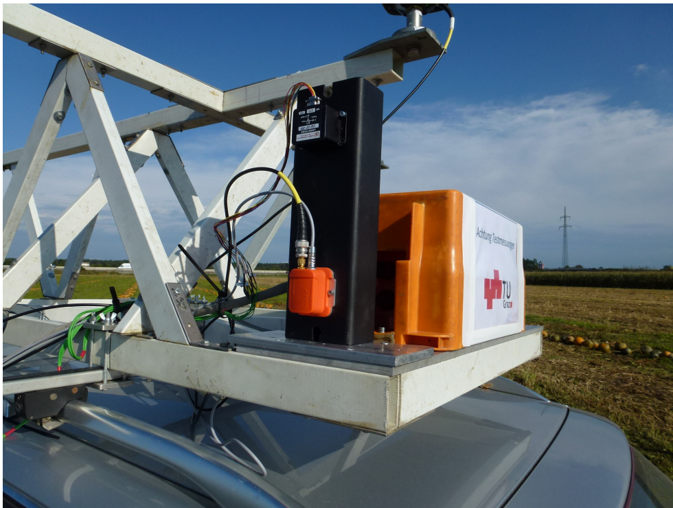
Abbildung 7.4: Bestimmung der Beschleunigungssensorbiases (1 Lage des 6-Lagentests)
