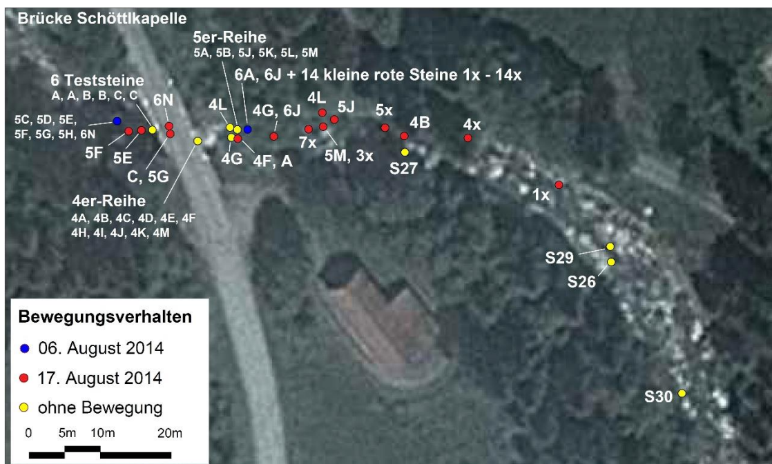
Abbildung 75: Bewegungsverhalten der Tracersteine zwischen dem 6. August 2014 und dem 17. August 2014
