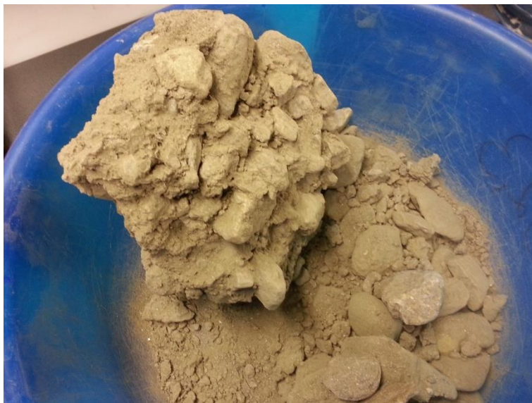
Abbildung 118: Kohäsion vom Scherversuchsmaterial aus dem Bachbett welches zur Wassergehaltsbestimmung bei 105° getrocknet wurde
