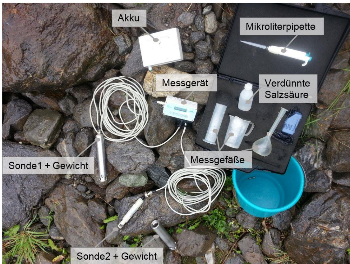
Abbildung 51: Salz-Tracer Messgerät samt Zubehör
