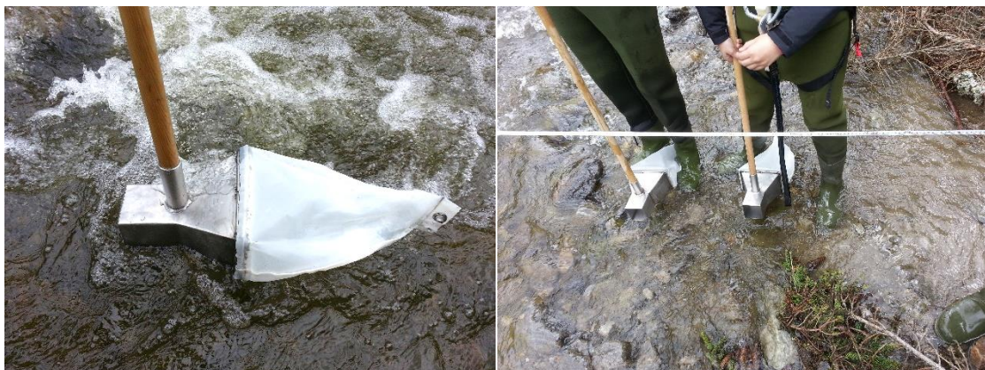
Abbildung 45 & 46: Kleine Helley-Smith-Geschiebefänger & Messung am Fließquerschnitt
