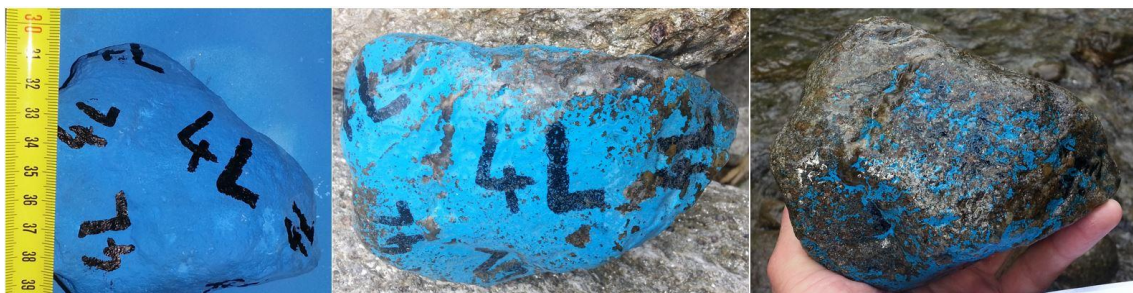
Abbildung 80: Abrasion im Schöttlbach nach einem bzw. vier Monaten
