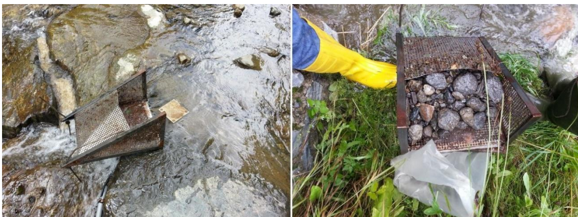
Abbildung 42 Links: Geschiebefangkorb am Querprofil der Sohlschwelle flussaufwärts der Brücke Schöttlkapelle
