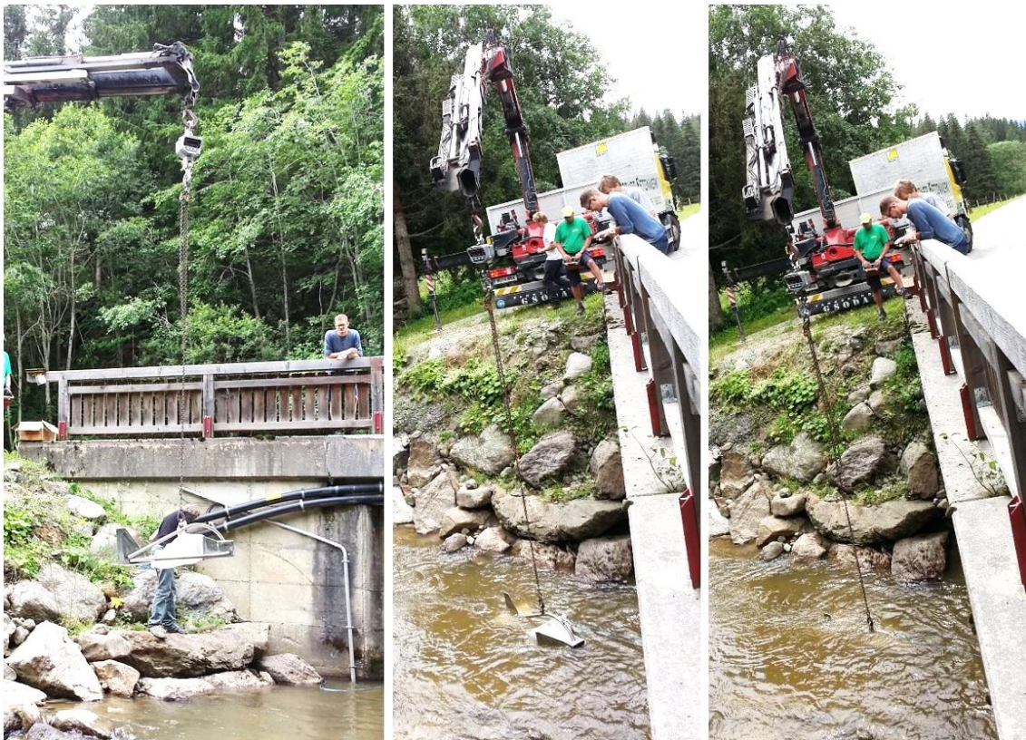
Abbildung 44: Ablauf der Geschiebemessung mittels Helley-Smith Geschiebefänger. Links und Mitte; beim Einheben in das Fließgewässer, rechts; absenken bis auf die Gewässersohle.
