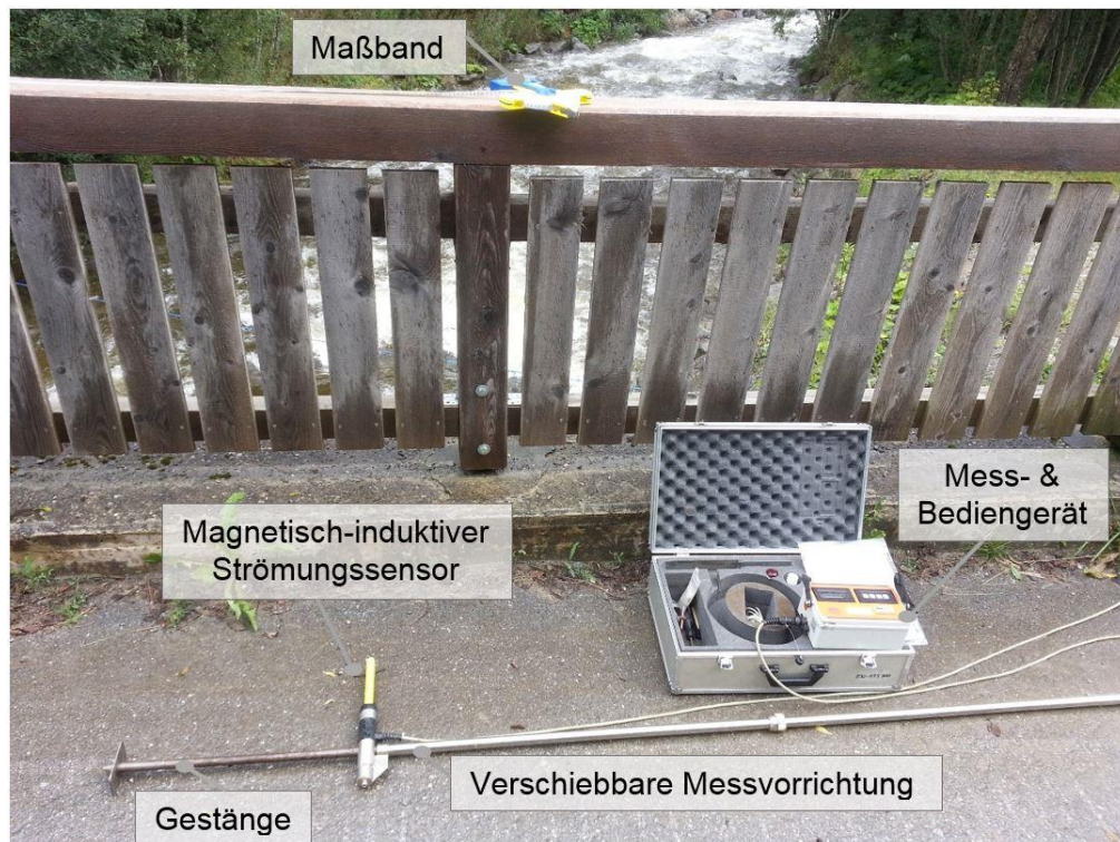
Abbildung 50: Nautilusmessgerät samt Zubehör
