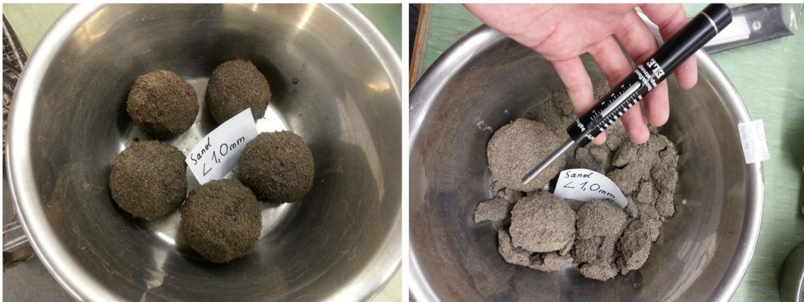
Abbildung 117: Festigkeitsermittlung der scheinbaren Kohäsion am Beispiel von Sandkugeln
