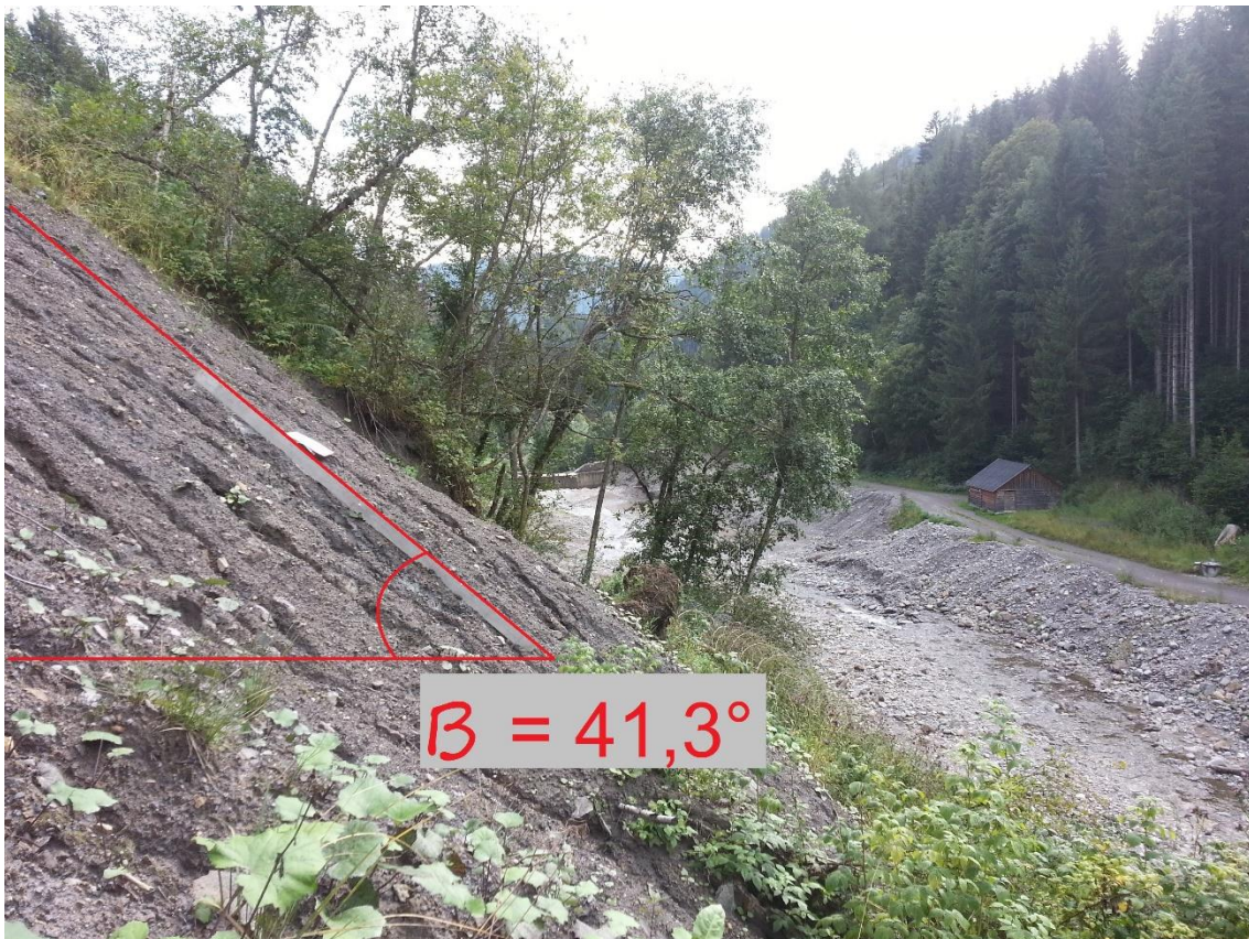
Abbildung 107: Böschungswinkel Beta im Mittel mit 41.3°
