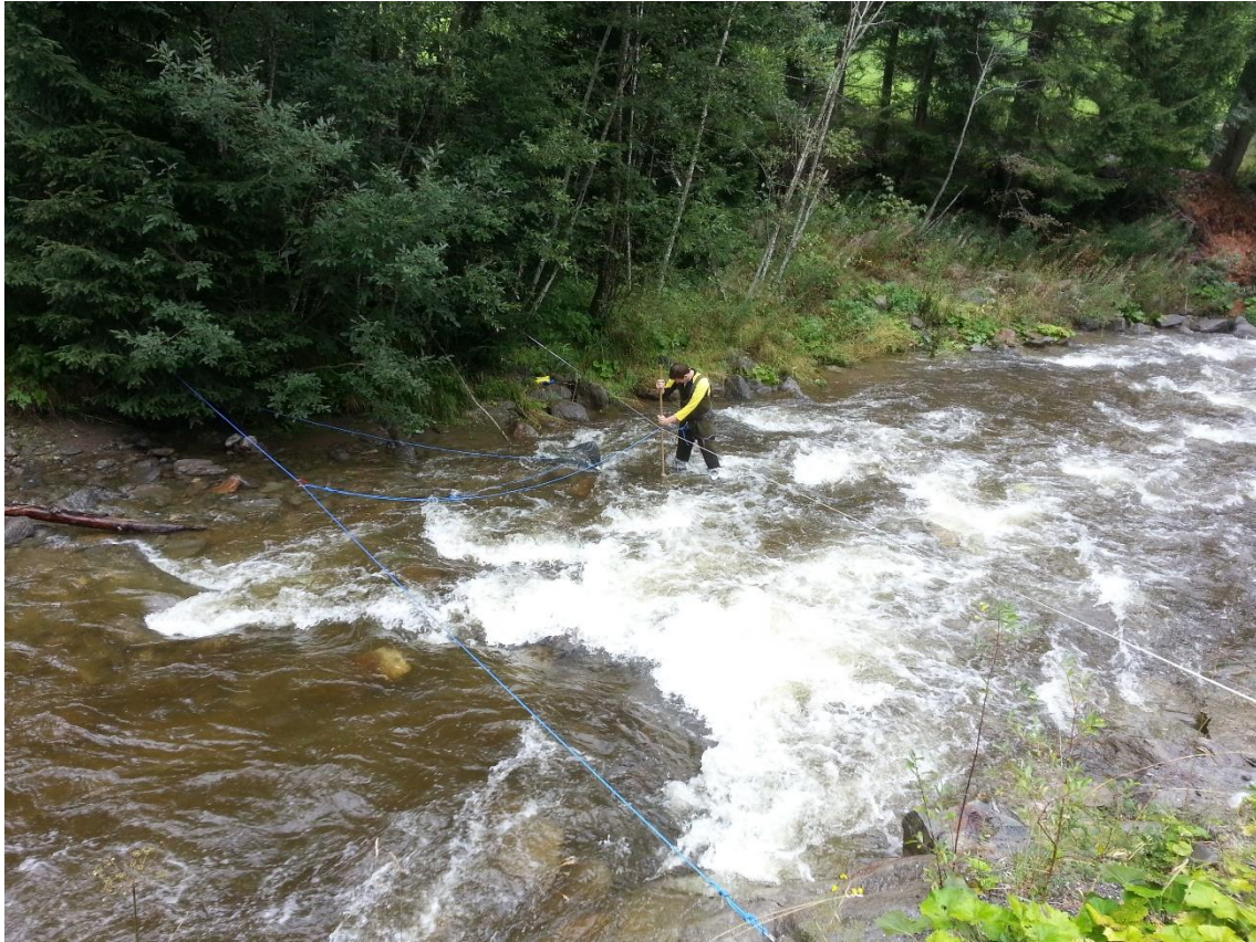
Abbildung 47: Kleine Helley-Smith Messung bei höheren Abflüssen
