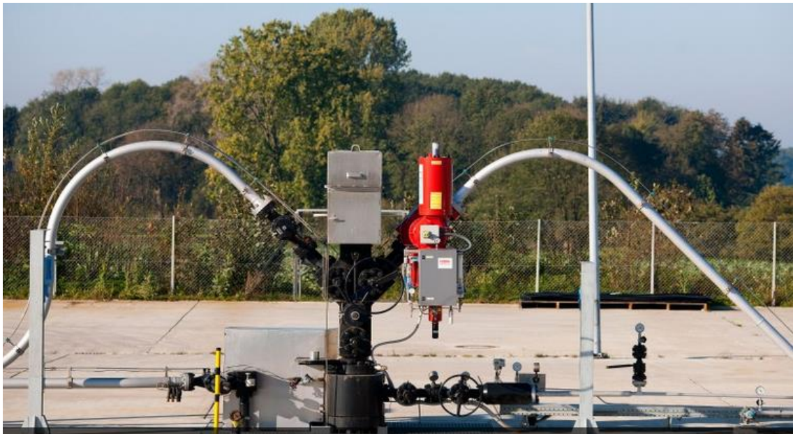
Abb. 34: Eruptionskreuz bzw. „Blowout Preventer“ (Exxon Mobil Central Europe Holding GmbH, 2014)
