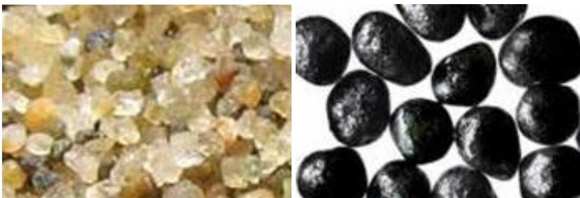
Abb. 35: Quarzsande für die Schiefergasförderung (links) und „Resin Coated Ceramic Proppants“ für die Schieferölförderung (rechts) (nach Horiba Scientific Ltd., 2014)
