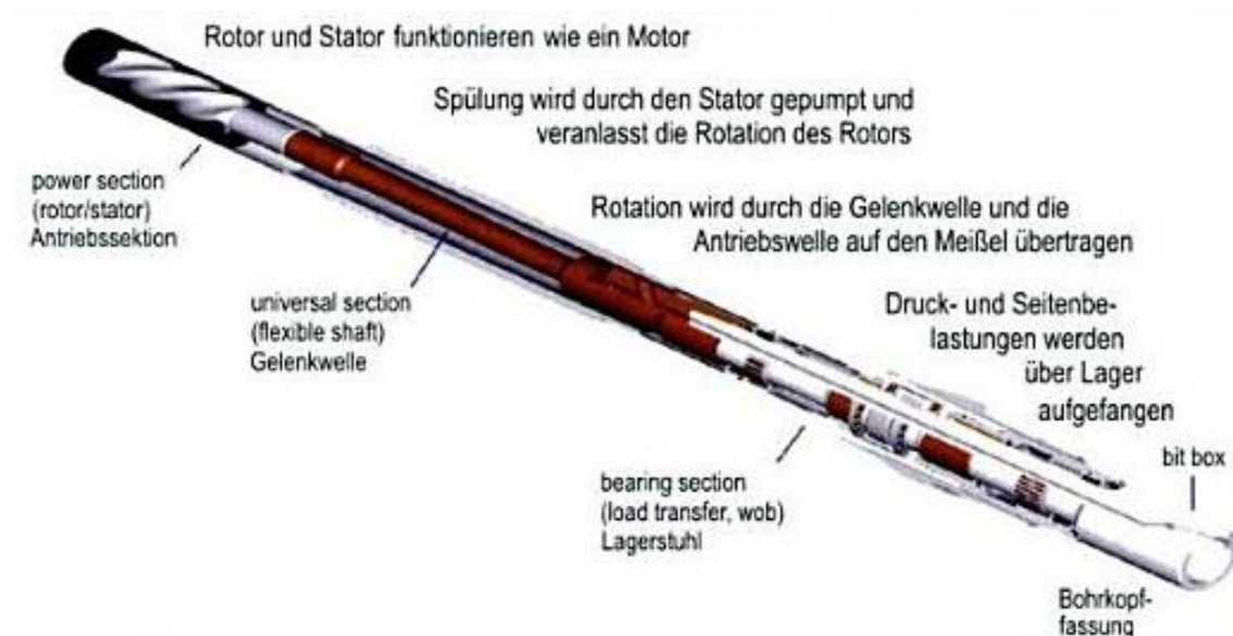
Abb. 12: Der „Mud Motor“ und seine Komponenten (Bayer, 2005)
