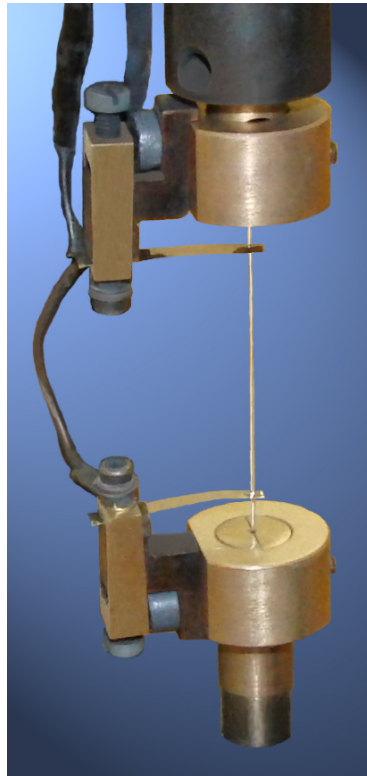
Abbildung 3.3: Darstellung der in den Probenhalter eingespannten Drahtprobe, an welche zur Messung des Spannungsabfalls zwei Molybdänspannungsschneiden angeklebmt sind.
