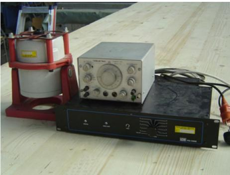
Abb. 4.3 Shaker (links) mit Steuereinheit (rechts) [7]
