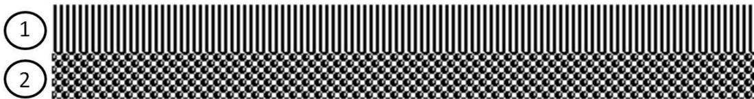
Abbildung 6 Sauerstoffelektroden bestehend aus einer Gasdiffusionsschicht (1) und einer Aktivschicht (2)
