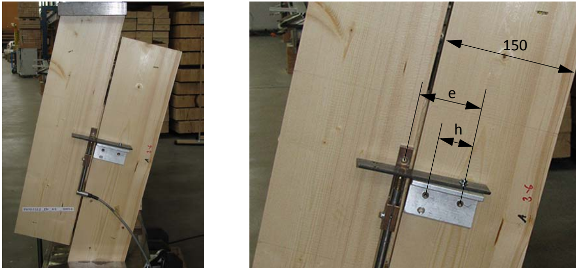
Abb. 3-25 Lokaler Wegaufnahme aufgeschraubt auf den Prüfkörper
