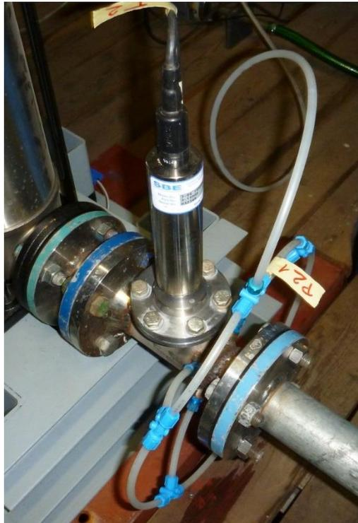
Abbildung 4.9: Messstelle des Validierungsprüfstandes zur direkten Messung (saugseitig)
