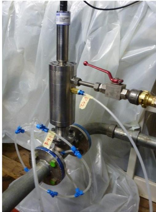
Abbildung 4.7: Messstelle des Validierungsprüfstandes mit Wasserentnahme (druckseitig)
