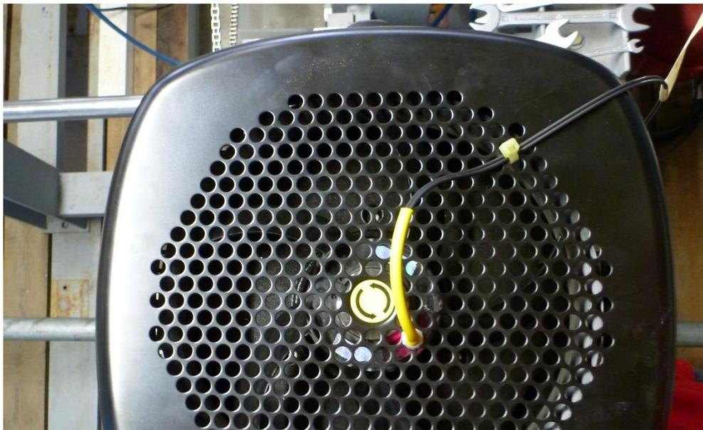
**Abbildung 4.10: Optischer Impulsgeber zur Drehzahlbestimmung**
