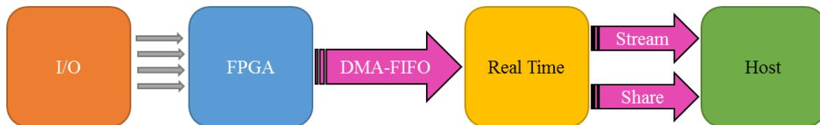
Abbildung 3.8: Ebenen und Kommunikationskanäle des Messsystems
